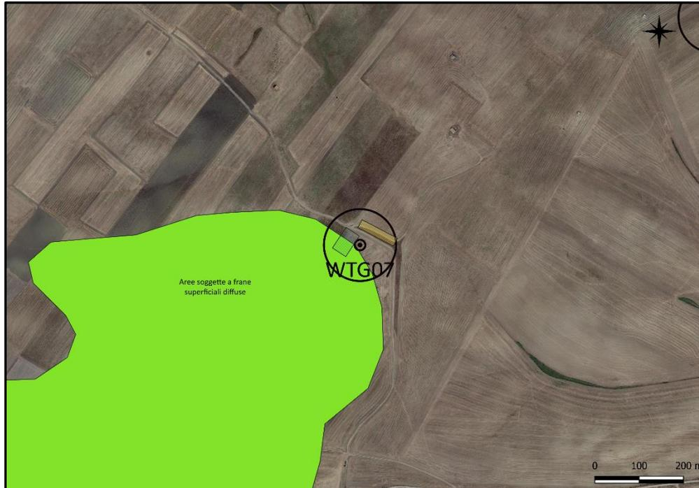
*Figura 30- Inquadramento aerogeneratore WTG07 rispetto ai dissesti censiti dal progetto IFFI*
