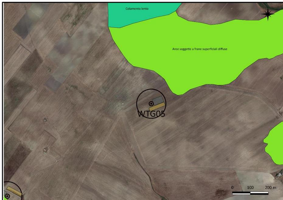
*Figura 24- Inquadramento aerogeneratore WTG05 rispetto ai dissesti censiti dal progetto IFFI*
