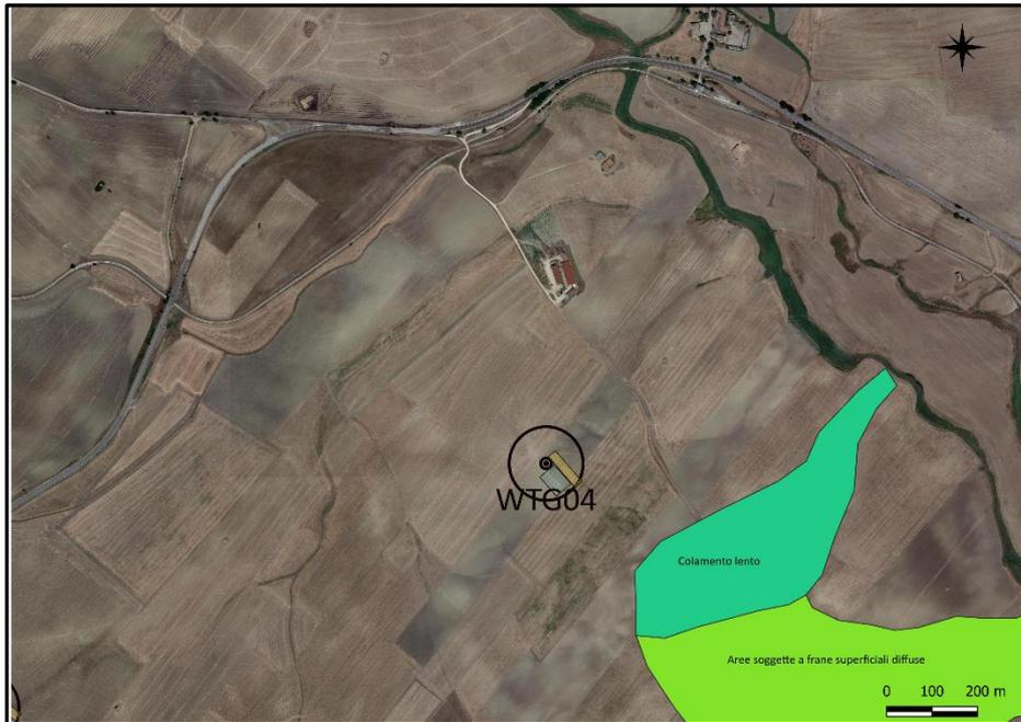
Figura 20 - Inquadramento aerogeneratore WTG04 rispetto i dissesti censiti dal progetto IFFI
