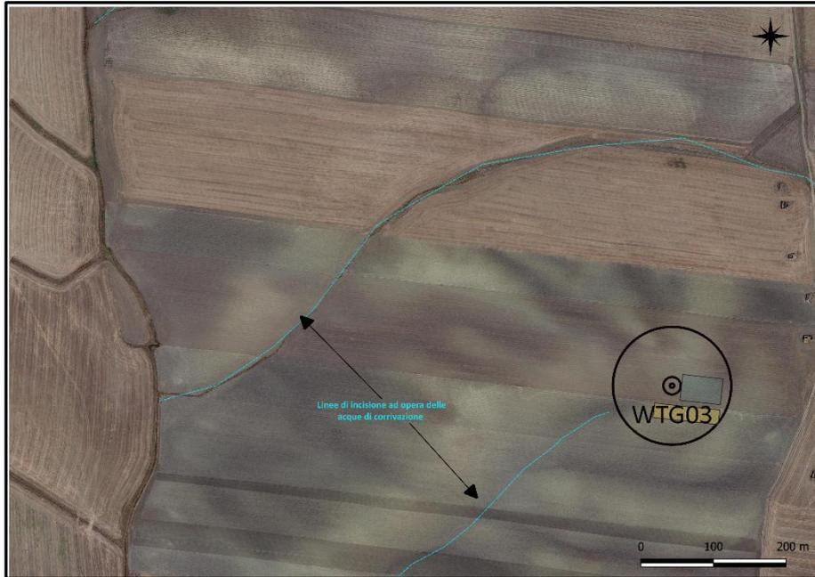
Figura 16- Inquadramento aerogeneratore WTG03 su ortofoto con indicazione delle linee di drenaggio preferenziali ed orientazione NE-SW. Le incisioni vanno a raccordarsi con l'asta torrentizia affluente del F.Bradano
