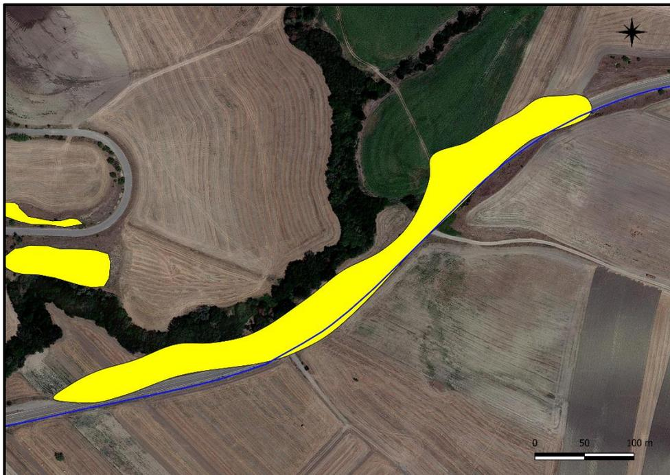
Figura 34 - Interferenza cavidotto di progetto con area a pericolosità geomorfologica moderata (R1)
