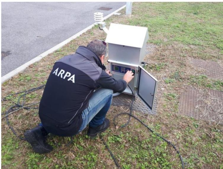
*Figura 3 - Esempio di campionatore per il monitoraggio della qualità dell'aria (Fonte: Arpa Lombardia)*
