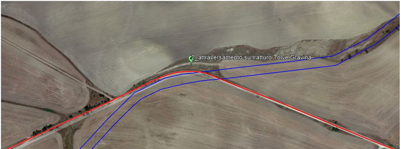
Figura 87 – La foto inquadra in rosso la traccia del cavidotto interrato su strada esistente, in blu la traccia del Regio Tratturo Tolve Gravina, (Fonte Google Earth).
