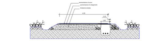
**SEZIONE TIPO- Cavidotto interrato**
