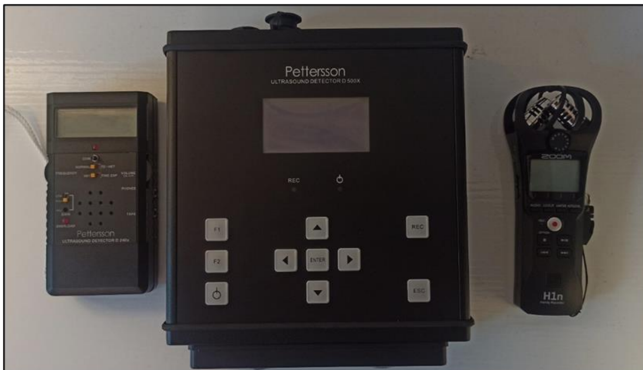
Figura 40: Attrezzatura utilizzata per il monitoraggio dei chiroteri. Da destra verso sinistra: Rilevatore a eterodina ed espansione temporale (x10 e x20 selezionabile). Bat detector D 500X per la registrazione prolungata in campo degli ultrasuoni. Registratore multitraccia collegato al D 240X.
