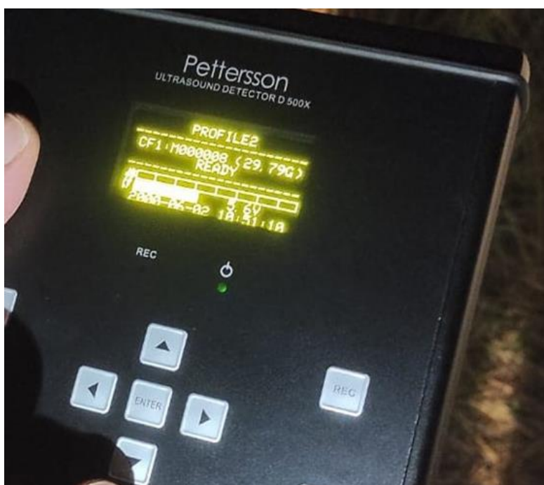
Figura 41: Preparazione del Bat Detector Petterson D500 x per i rilievi su postazione fissa prolungata. Il D500X è un'unità di registrazione a ultrasuoni destinata alla registrazione a lungo termine e incustodita delle chiamate dei pipistrelli.
