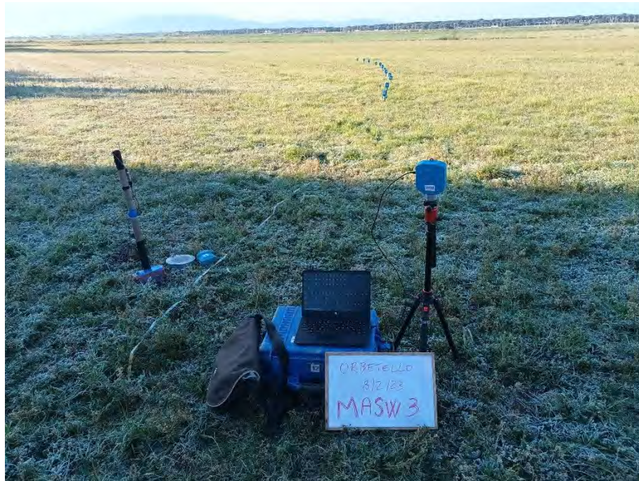
Postazione della MASW 03
