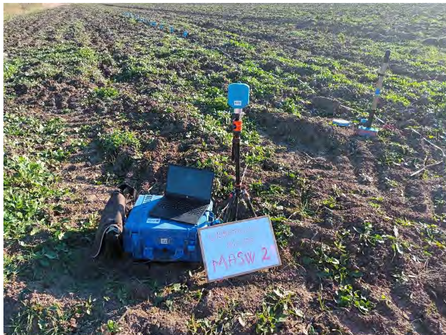
Postazione della MASW 02
