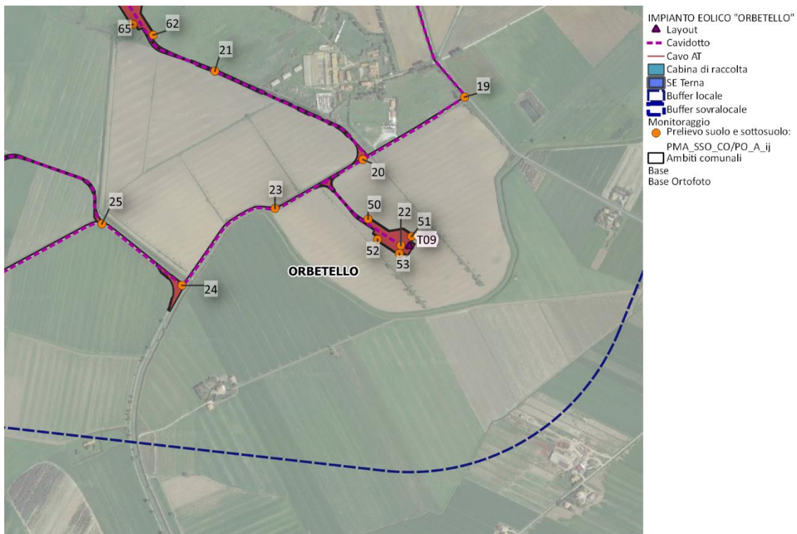
Figura 7. Stralcio planimetrico con indicazione dei punti di campionamento componente suolo e sottosuolo (PMA_SSO_CO/PO_A_ij)
