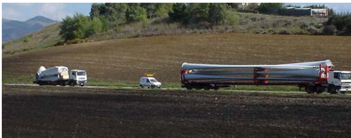
Figura 6 Trailer di 26 m per il trasporto delle pale di un aerogeneratore :
