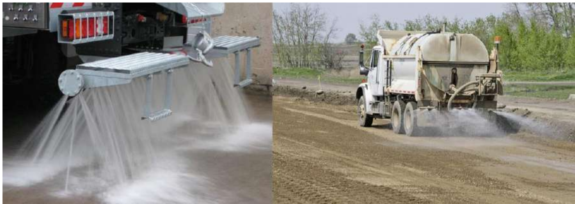
Figura 5-16: Automezzo per la bagnatura delle piste sterrate
