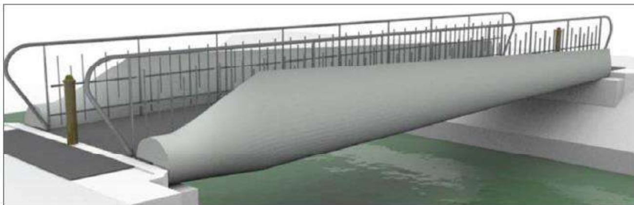
Figura 4-29: Esempio di riutilizzo: Un progetto concettuale di ponte pedonale che utilizza pale eoliche come travi principali - progetto di ricerca Re-Wind
