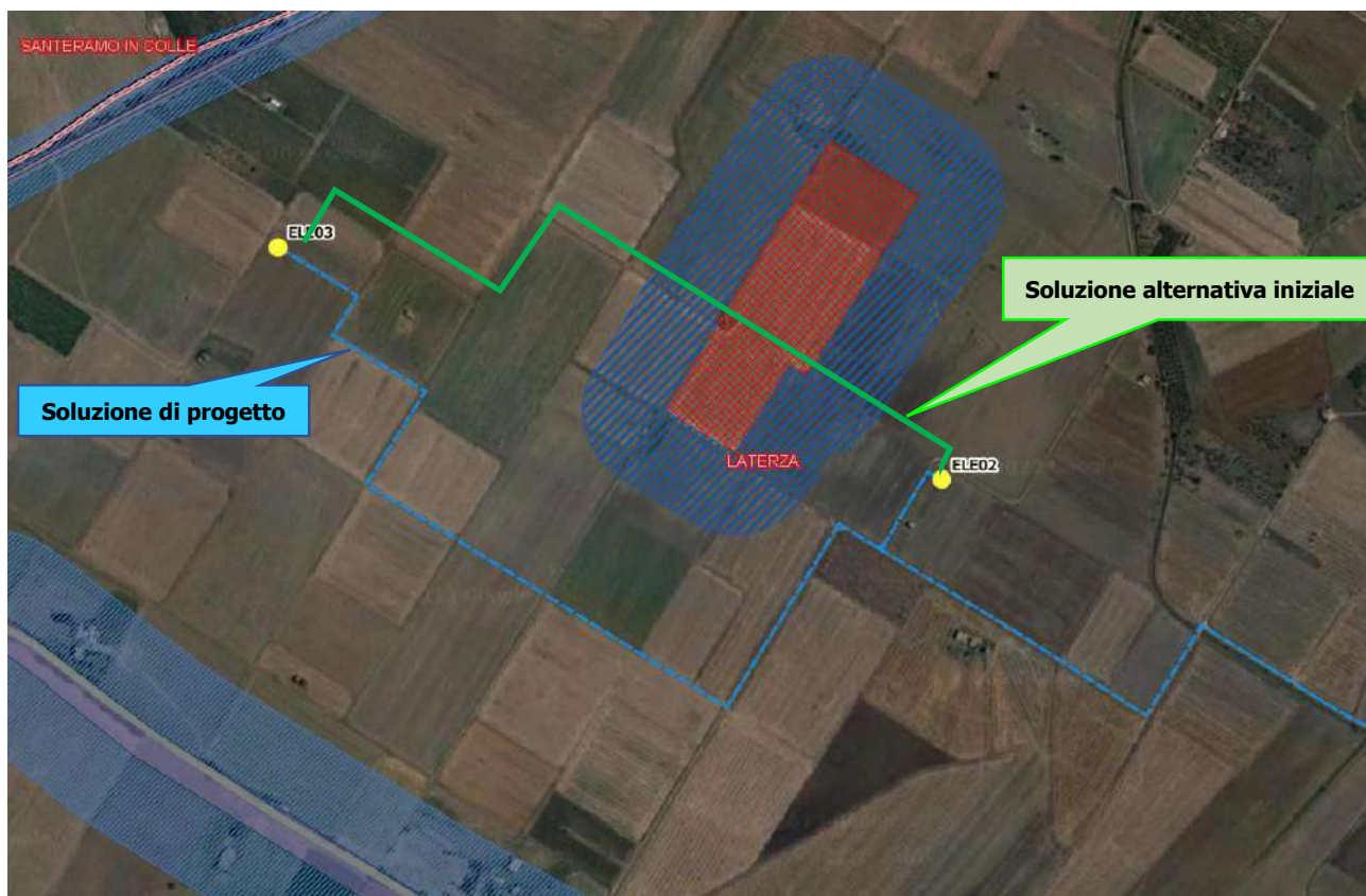
Figura 4-6: Spostamento tracciato cavidotto - Alternativa 2
