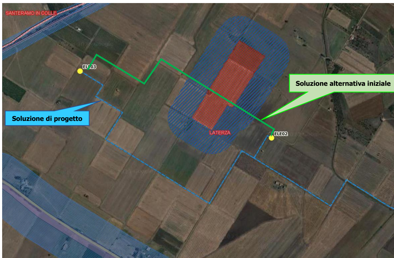
Figura 11-6: Spostamento tracciato cavidotto - Alternativa 2
