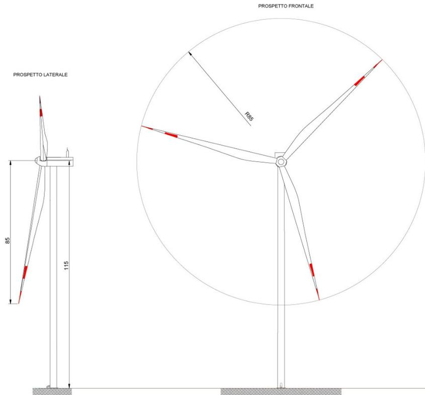
**Figura c-1: Struttura aerogeneratore**
