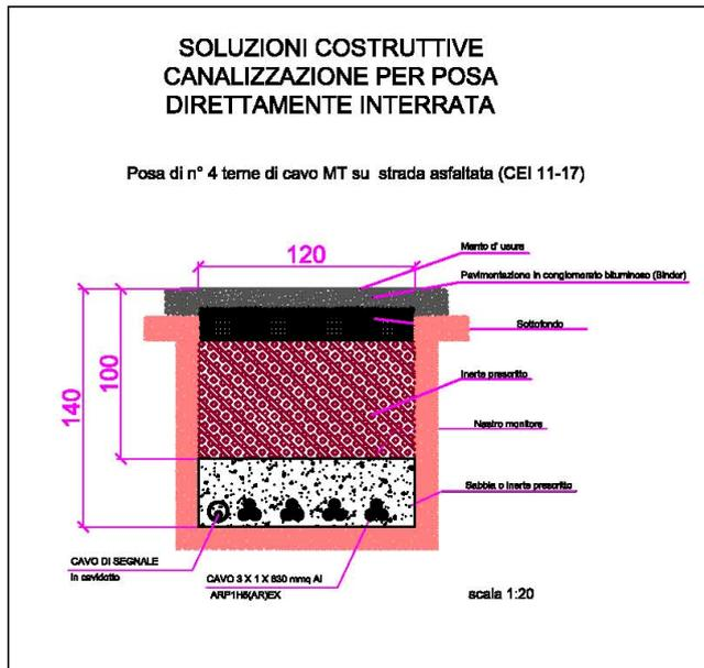
**Figura 4-2: – Modalità di posa cavo ARP1H5(AR)EX unipolare 18/30 kV**
