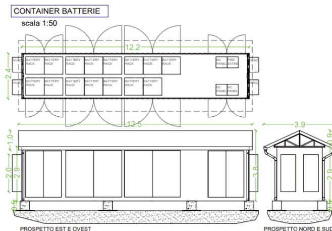
Figura 8: Container Batterie – Pianta e Prospetto
