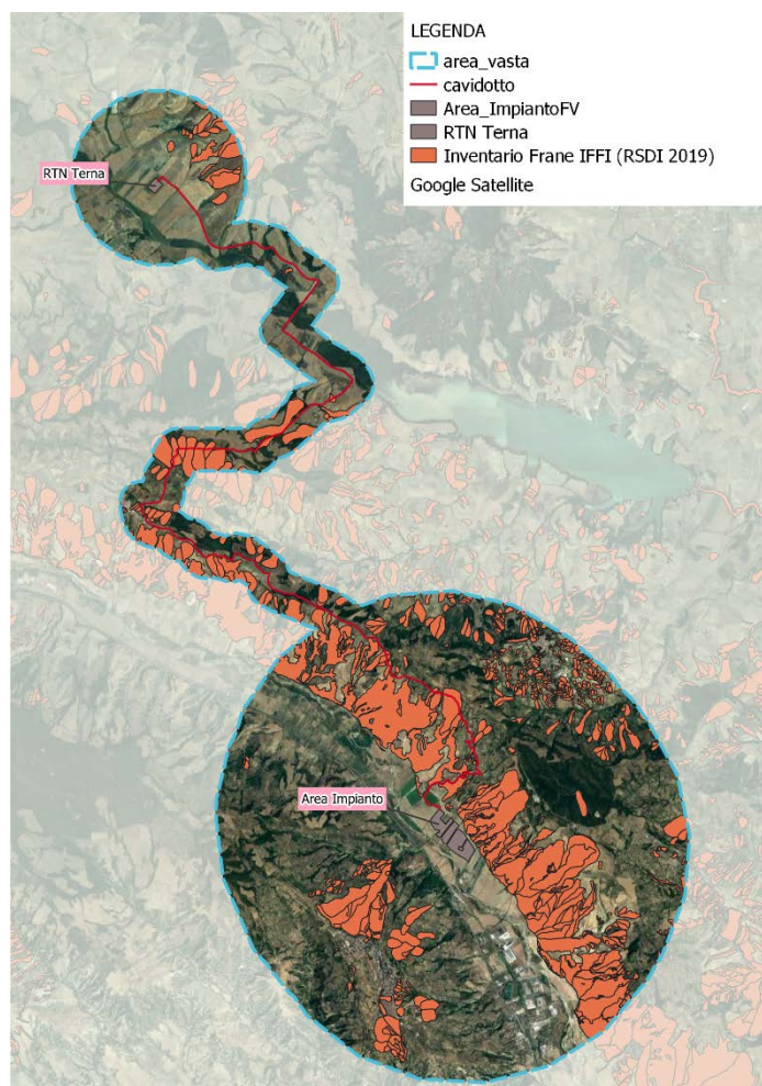
Figura 16: Movimenti franosi censiti nell'ambito del progetto IFFI presenti nell'area vasta di analisi (Fonte: ns. elaborazioni su dati https://www.isprambiente.gov.it/it/progetti/cartella-progetti-in-corso/suolo-e-territorio-1/iffi-inventario-dei-fenomeni-franosi-in-italia )
