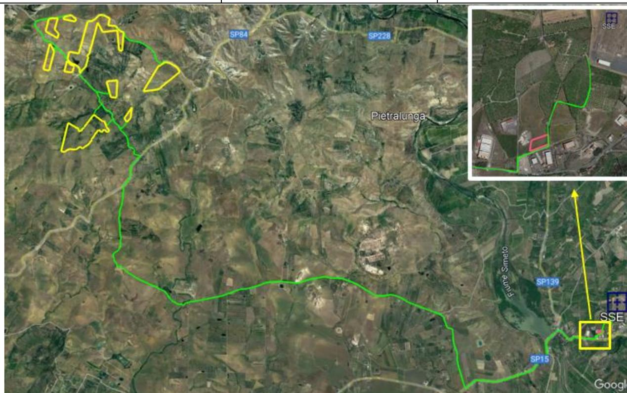
Figura 5 – Inquadramento su Google Earth dell’area di impianto (in giallo) e del tracciato del cavidotto di connessione MT (in verde); in magenta la cabina utente; in blu la SE Terna.
