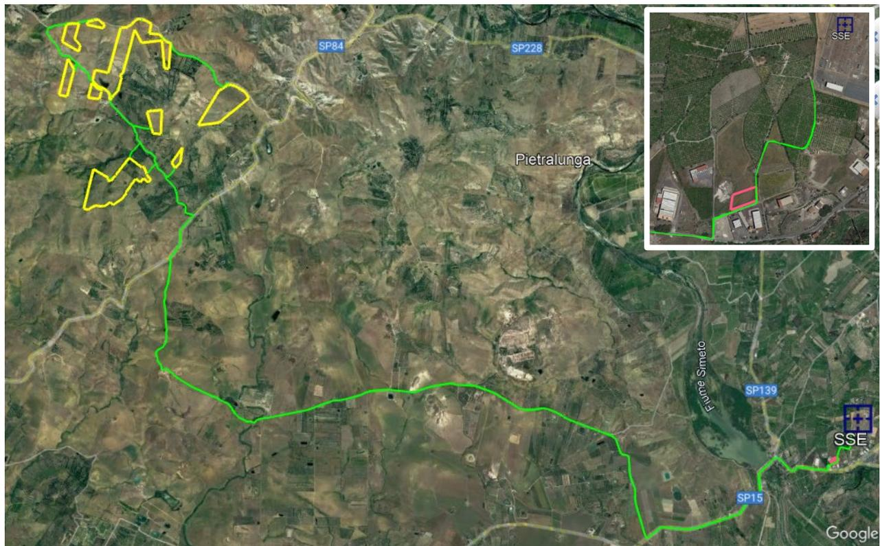
**Figura 6 – Inquadramento su Google Earth dell'area di impianto (in giallo) e del tracciato del cavidotto di connessione MT (in verde); in magenta la cabina utente; in blu la SE Terna.**
