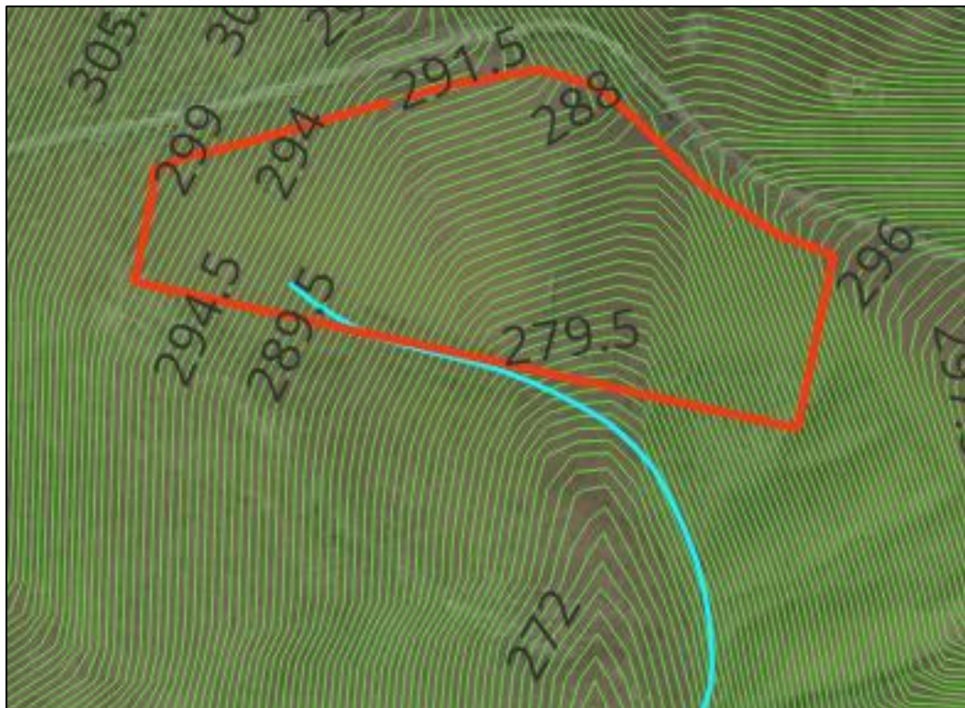
Figura 36: Inquadramento su ortofoto e curve di livello (in verde) da rilievo topografico dei canali idrici (in ciano). In rosso la perimetrazione dell'area di impianto.
