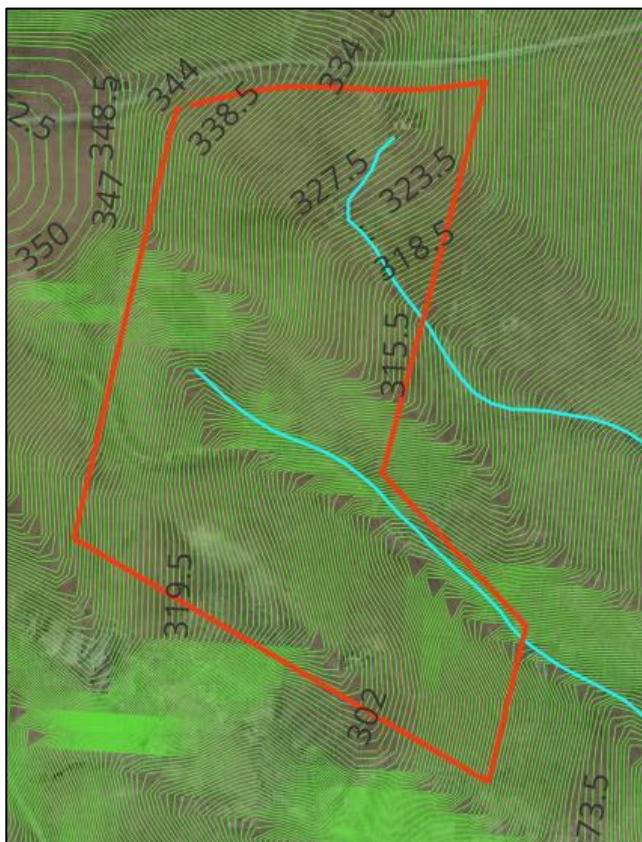
Figura 34: Inquadramento su ortofoto e curve di livello (in verde) da rilievo topografico dei canali idrici (in ciano). In rosso la perimetrazione dell'area di impianto.
