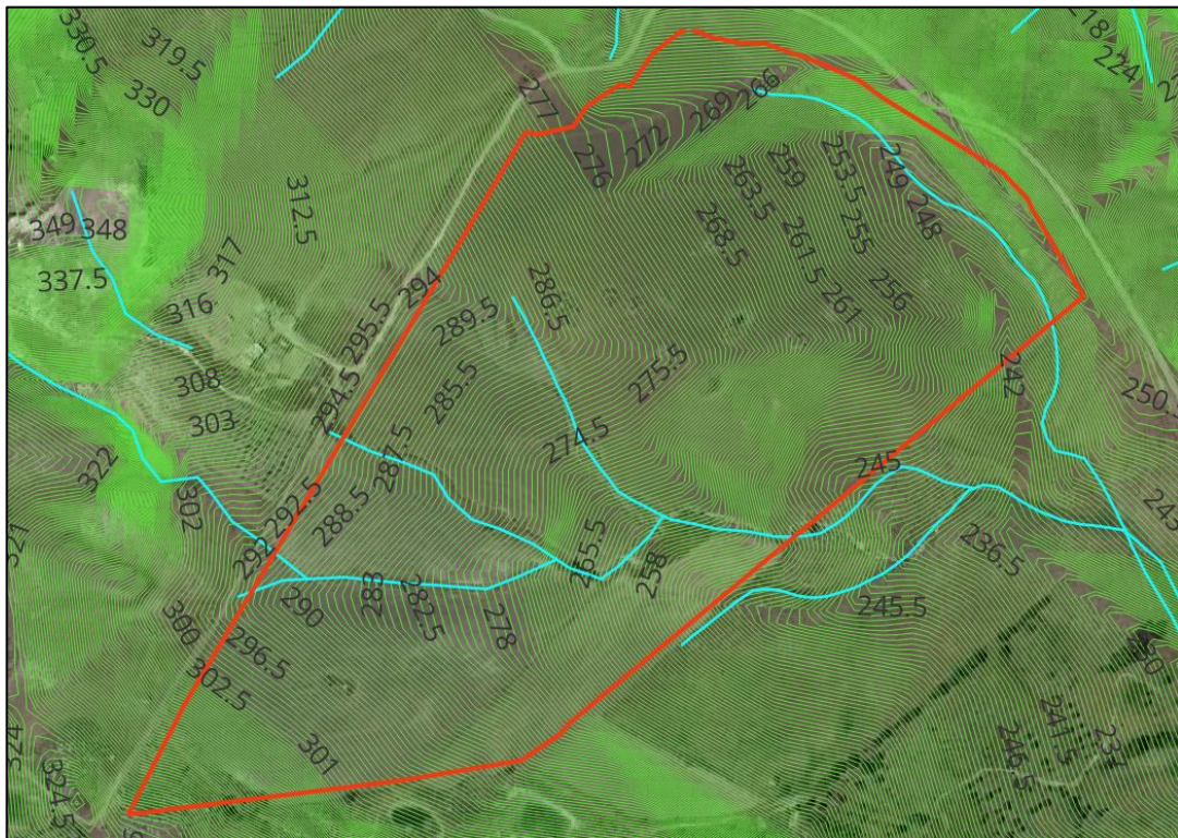
Figura 46: Inquadramento su ortofoto e curve di livello (in verde) da rilievo topografico dei canali idrici (in ciano). In rosso la perimetrazione dell'area di impianto.
