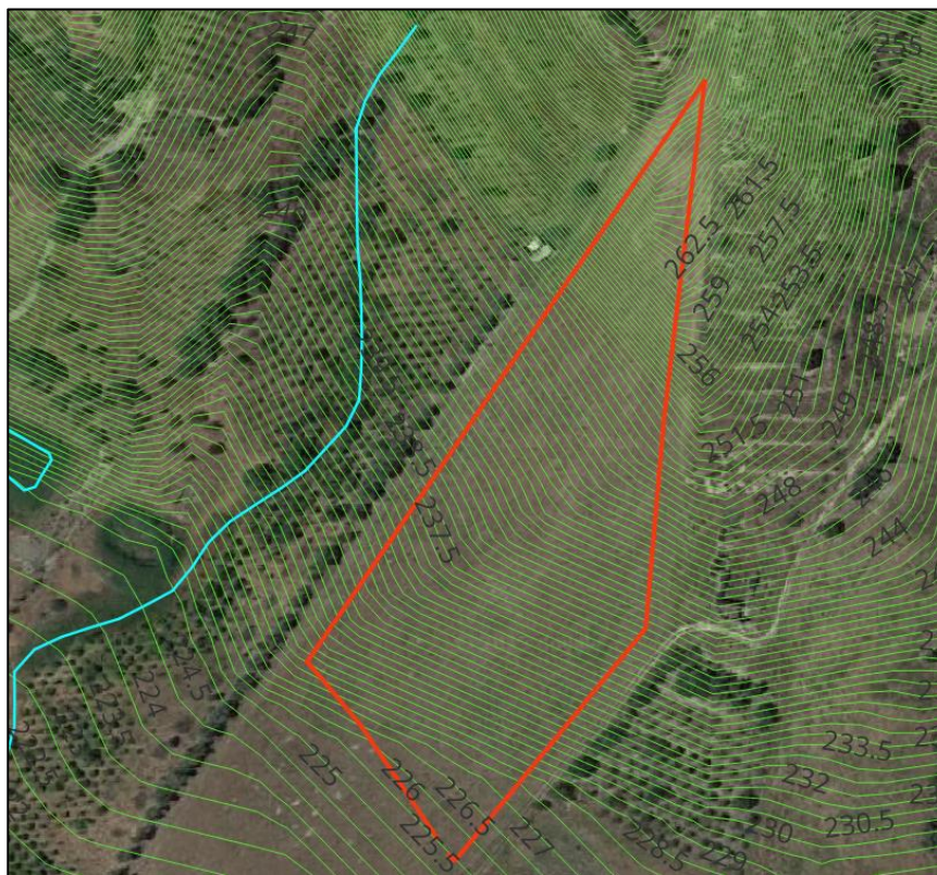
Figura 48: Inquadramento su ortofoto e curve di livello (in verde) da rilievo topografico dei canali idrici (in ciano). In rosso la perimetrazione dell'area di impianto.
