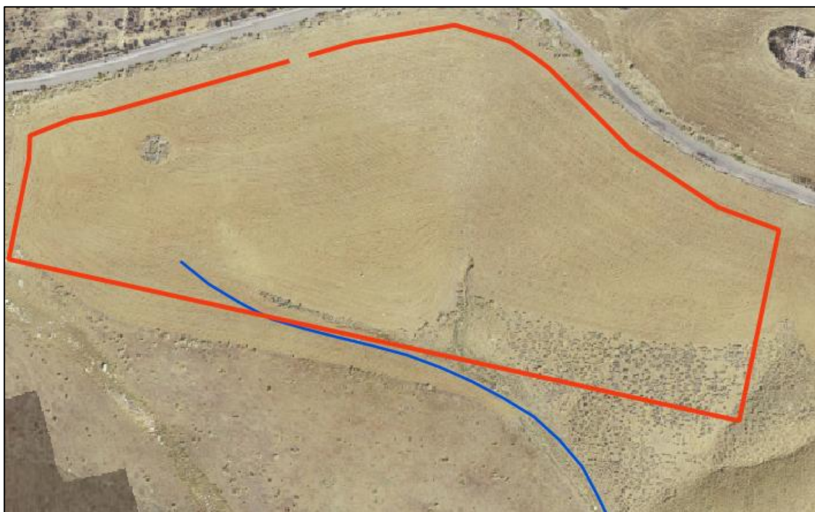
Figura 37: Inquadramento su ortofoto dei canali idrici perimetrati dal reticolo idrografico della Sicilia (in blu). In rosso la perimetrazione dell'area di impianto
