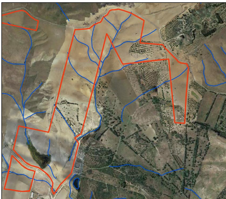
Figura 41: Inquadramento su ortofoto dei canali idrici perimetrati dal reticolo idrografico della Sicilia (in blu). In rosso la perimetrazione dell'area di impianto.
