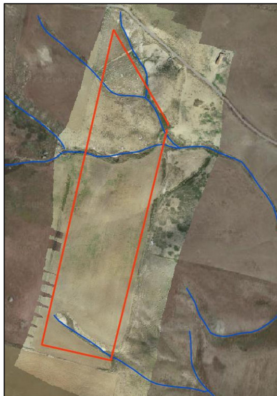
Figura 39: Inquadramento su ortofoto dei canali idrici perimetrati dal reticolo idrografico della Sicilia (in blu). In rosso la perimetrazione dell'area di impianto.
