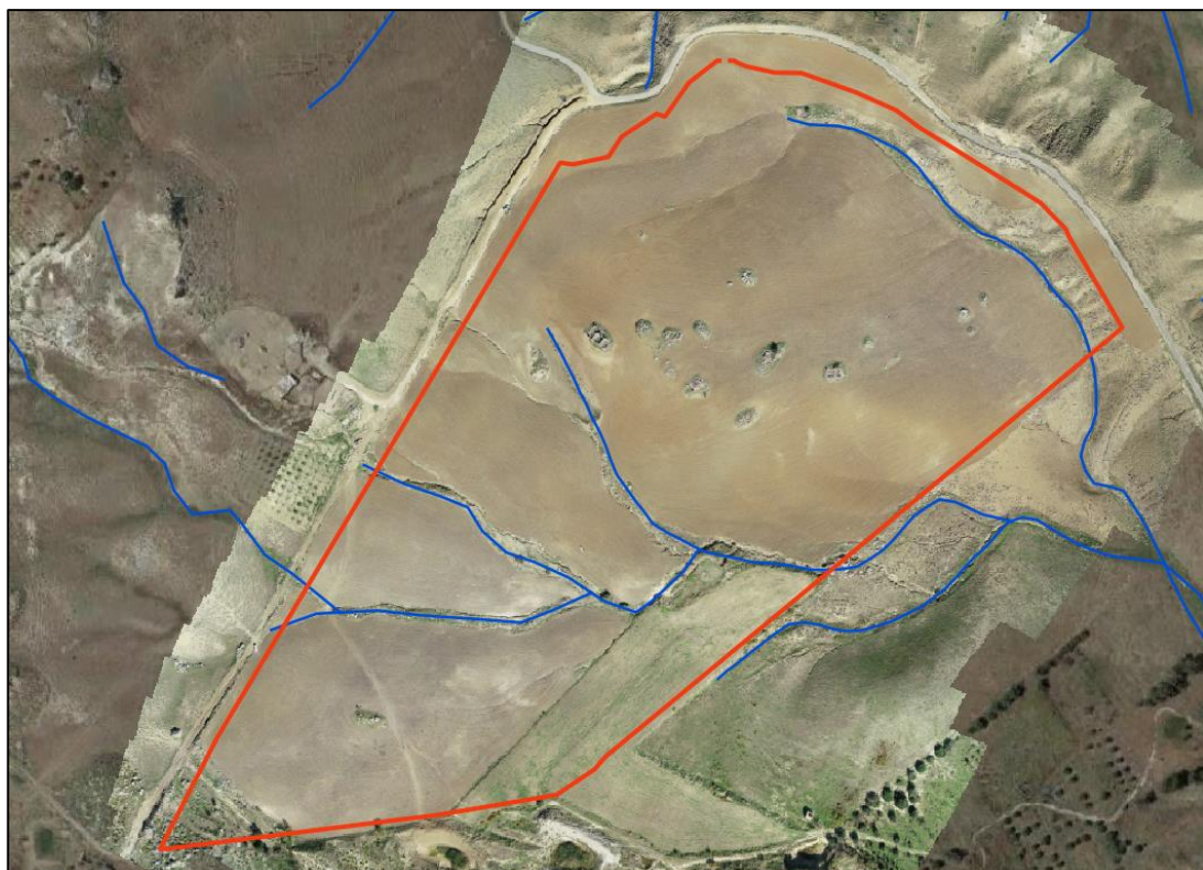
Figura 47: Inquadramento su ortofoto dei canali idrici perimetrati dal reticolo idrografico della Sicilia (in blu). In rosso la perimetrazione dell'area di impianto.
