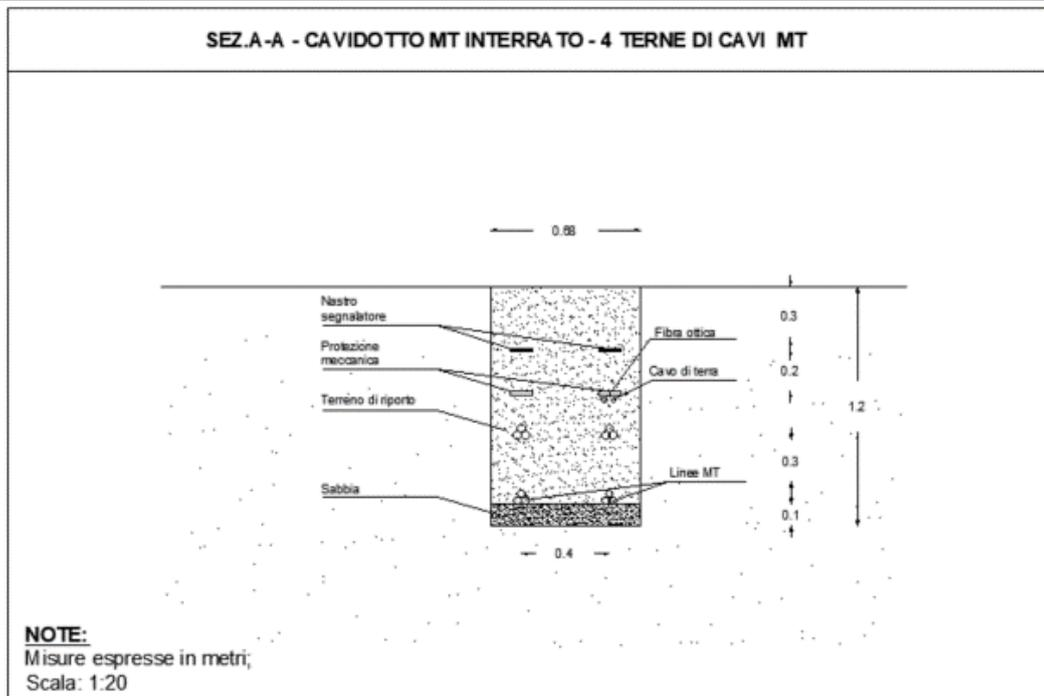
**Figura 5 - Tipologico di posa per quattro terne di cavi MT nello stesso scavo**
