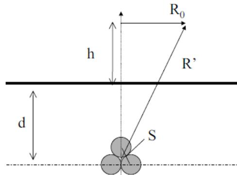
**Figura 6: Illustrazione dei parametri geometrici per la definizione della DPA**
