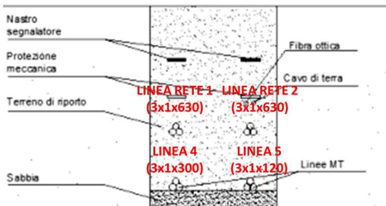
Figura 12 - Ipotesi di disposizione delle quattro terne nel caso peggiore con n.2 in formazione 3x1x630 mmq, n.1 in formazione 3x1x120 mmq e n.2 in formazione 3x1x300 mmq
