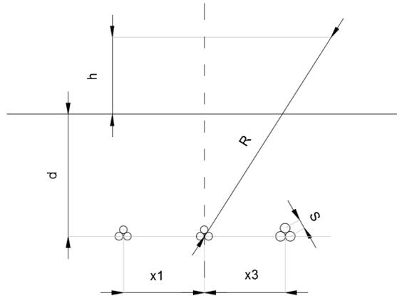
**Figura 9: Sistema di riferimento per la valutazione dei campi magnetici nel caso di tre terne posate all'interno della medesima trincea**
