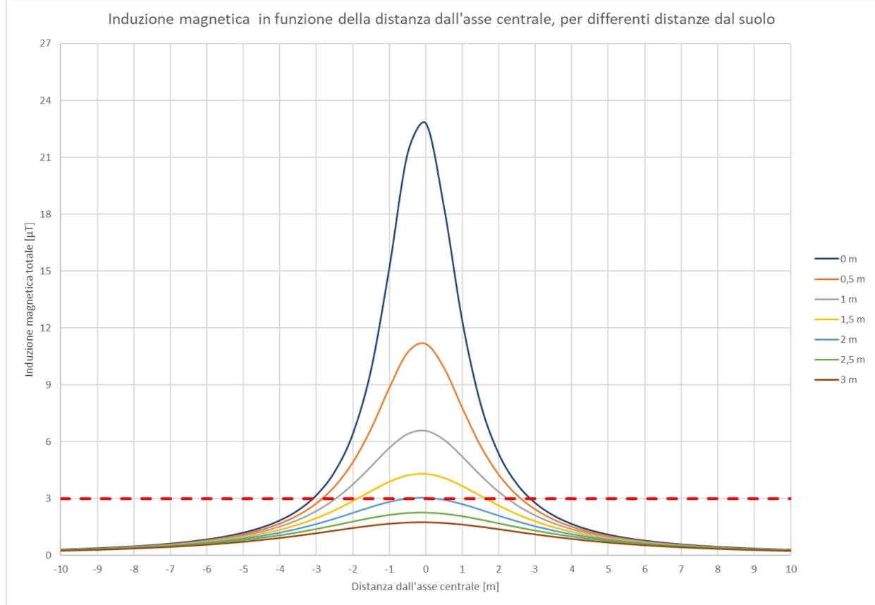
**Figura 10 - Andamento dell'intensità del campo magnetico nel caso posa di tre terne di cavi nello stesso scavo al variare della distanza dal livello del suolo e della distanza dal baricentro delle terne di cavi. In rosso l'obiettivo di qualità imposto dalla norma**
