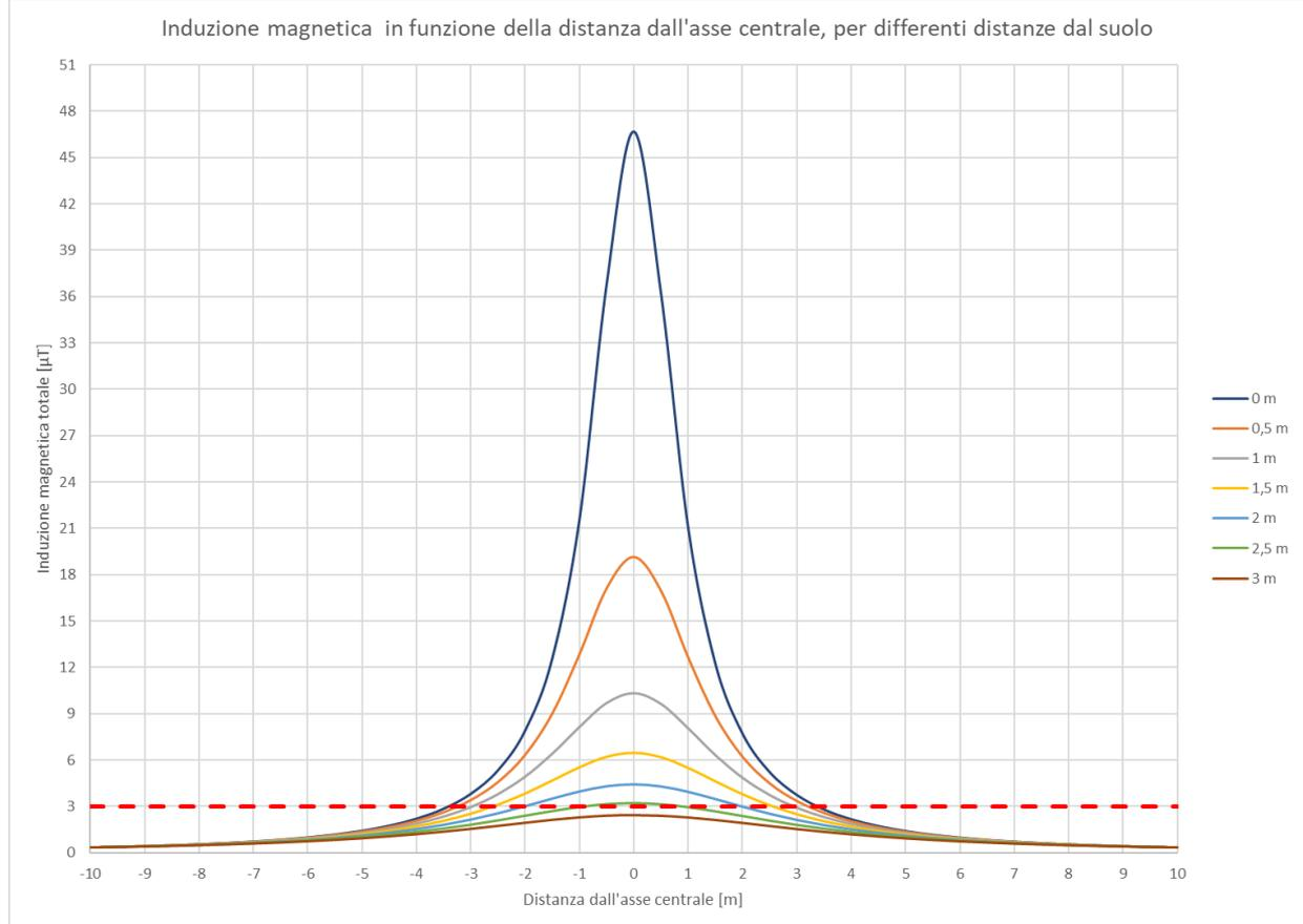
**Figura 13 - Andamento dell'intensità del campo magnetico nel caso posa di quattro terne di cavi nello stesso scavo al variare della distanza dal livello del suolo e della distanza dal baricentro delle terne di cavi. In rosso l'obiettivo di qualità imposto dalla norma**
