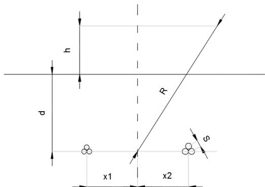
**Figura 7: Sistema di riferimento per la valutazione dei campi magnetici nel caso di due terne posate all'interno della medesima trincea**
