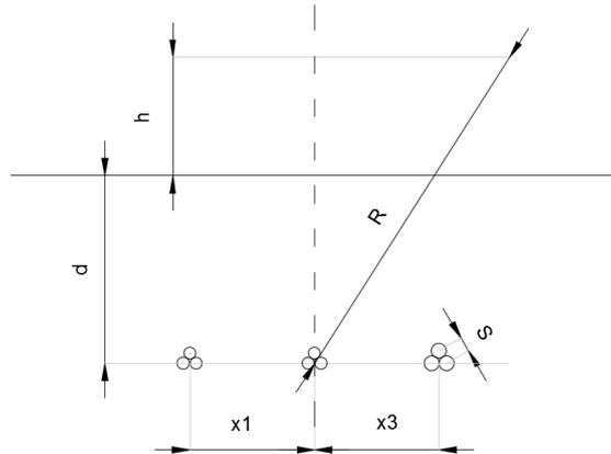
**Figura 11: Sistema di riferimento per la valutazione dei campi magnetici nel caso di quattro terne posate all'interno della medesima trincea**
