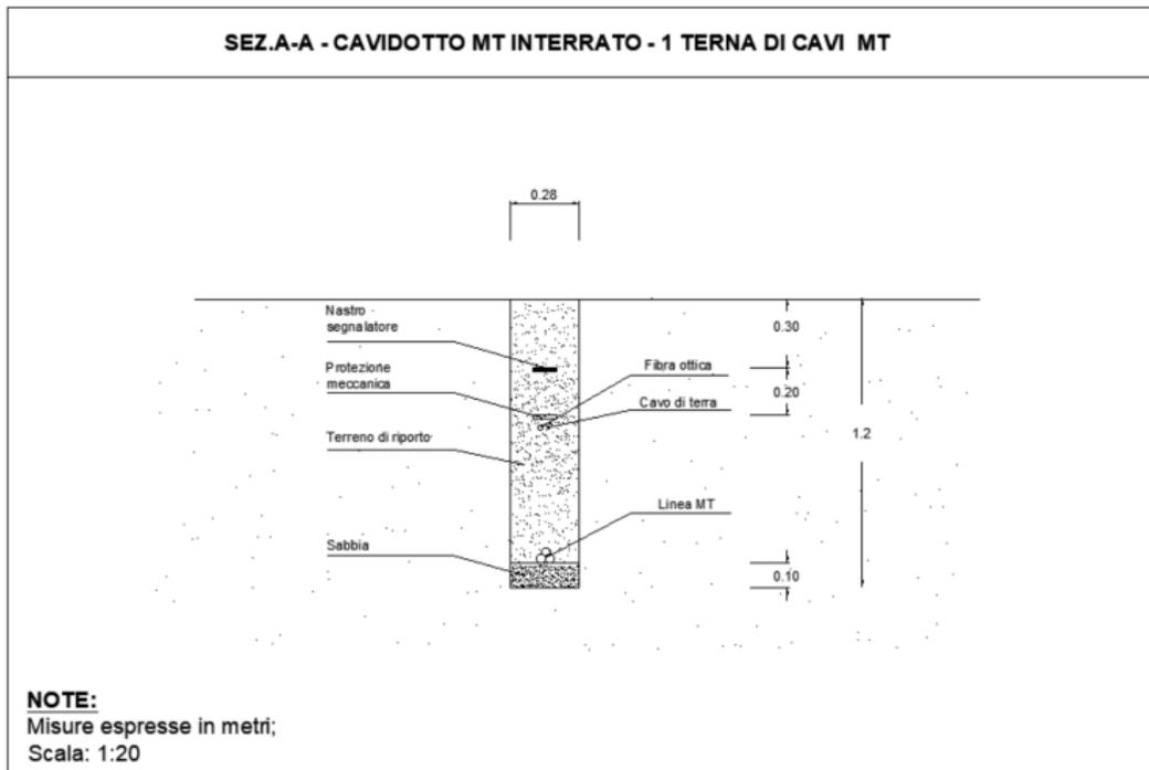
**Figura 2 - Tipologico di posa per una terna di cavi MT nello stesso scavo**
