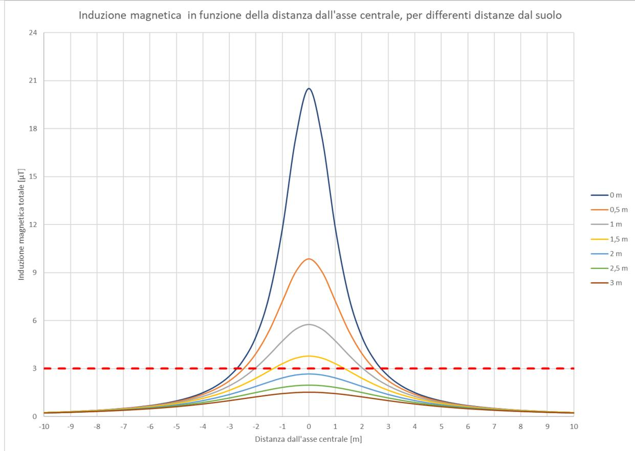
**Figura 8 - Andamento dell'intensità del campo magnetico nel caso posa di due terne di cavi nello stesso scavo al variare della distanza dal livello del suolo e della distanza dal baricentro delle terne di cavi. In rosso l'obiettivo di qualità imposto dalla norma**
