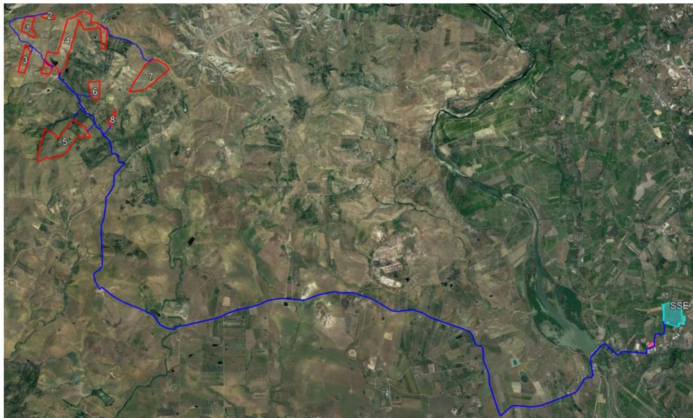
**Figura 1 - Inquadramento dei lotti di impianto (in rosso), della Sottostazione Elettrica Terna (in ciano) e della Cabina Utente (in rosa); in blu è rappresentato il tracciato del cavidotto MT che collega l'impianto agrivoltaico con la Stazione Elettrica.**
