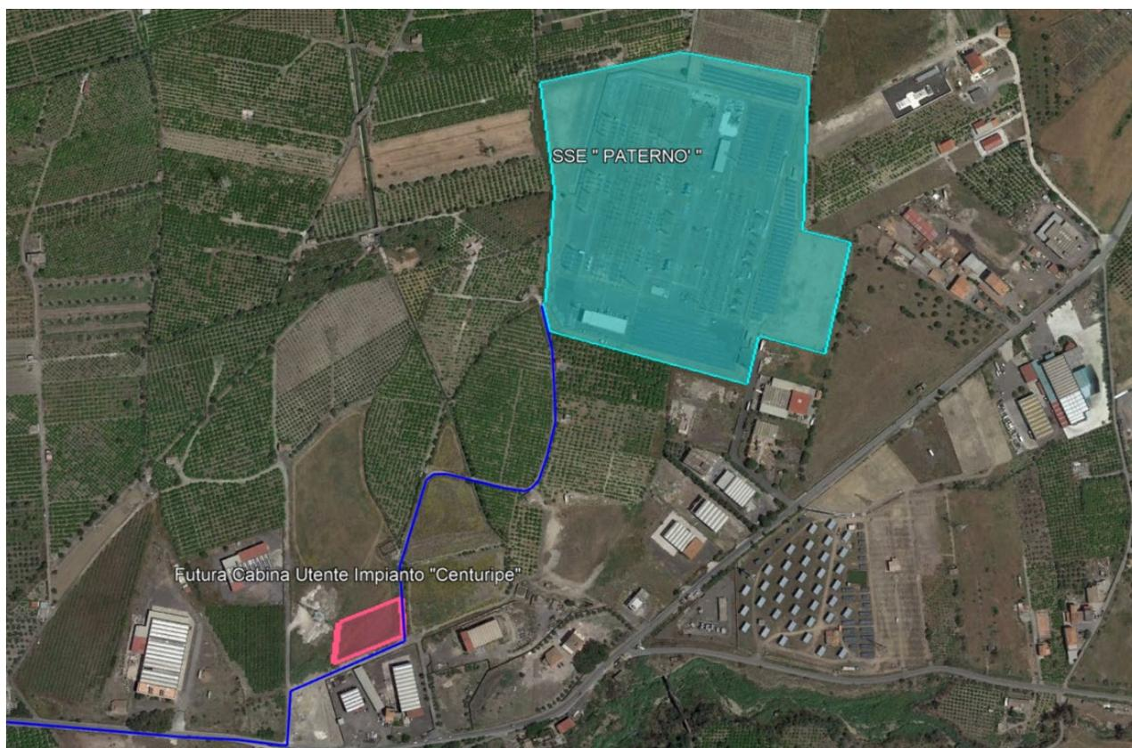
**Figura 3 – Inquadramento su ortofoto della Stazione Elettrica di Trasformazione (SE) a 380/150/36 kV di Paternò e delle aree limitrofe. In ciano la Sottostazione Elettrica (SSE) esistente e in rosa la Cabina Utente dell'impianto "San Todaro", in blu il tracciato del cavidotto MT che collega l'impianto agrivoltaico con la Stazione Elettrica.**
