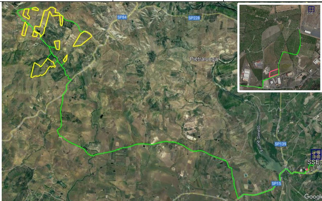
**Figura 2 – Inquadramento su Google Earth dell’area di impianto (in giallo) e del tracciato del cavidotto di connessione MT (in verde); in magenta la Stazione Elettrica Utente (SEU); in blu la SE Terna.**
