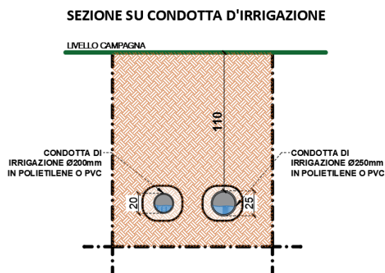
Figura 25: Sezione di dettaglio condotte di irrigazione d’adduzione
