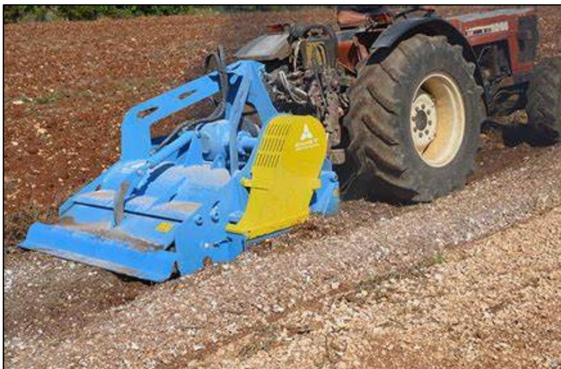
Al fine di migliorarne ulteriormente la fertilità sul filare avverrà la frantumazione delle pietre (tale operazione sarà accorpata con l'interramento del materiale ammendante). L'operazione di riduzione della granulometria è prevista tramite la frantumazione delle pietre a livello superficiale.
