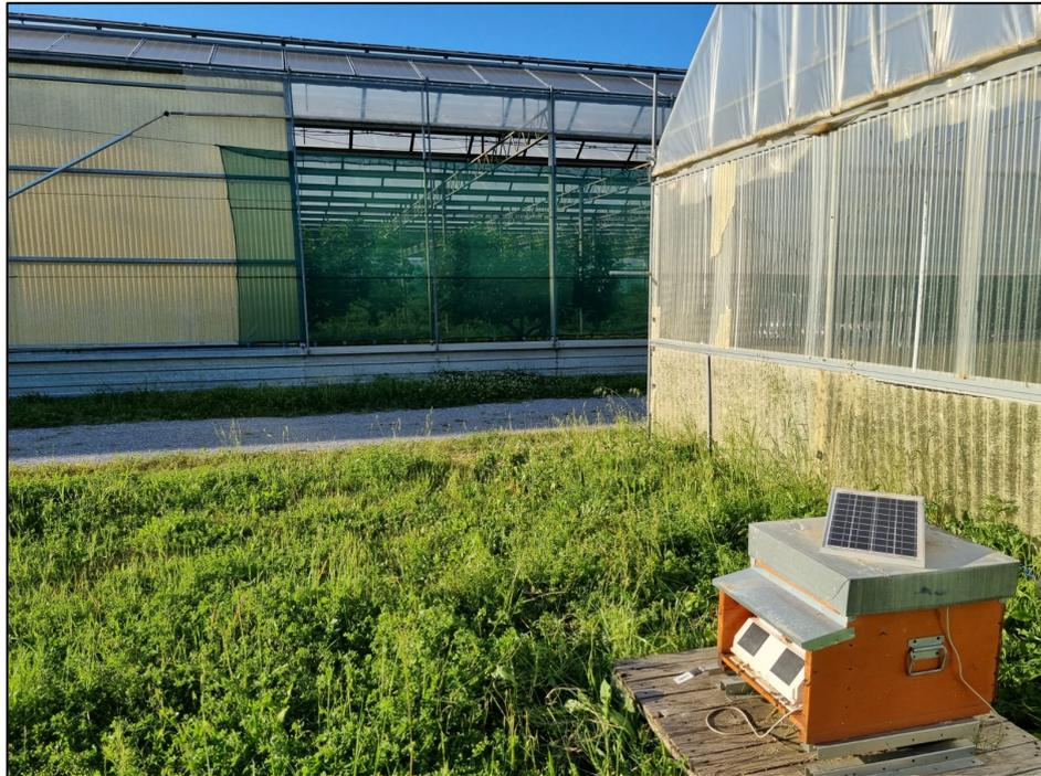
*Foto 8: Arnia posizionata nell'impianto calabrese di Scalea. Si nota un piccolo pannello solare posto sull'arnia, che mantiene attivi i sensori per misurare i parametri di seguito descritti ed il sistema di monitoraggio dei voli all'ingresso dell'arnia.*
