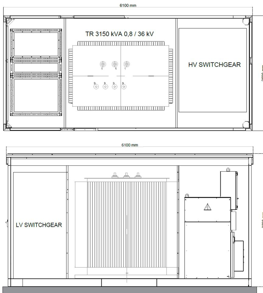
Storage container e Storage Power Station: si tratta di un container prefabbricato chiuso corredata di pacchi batterie e di un'apparecchiatura preassemblata e corredata di inverter, trasformatore e quadro BT/AT.
