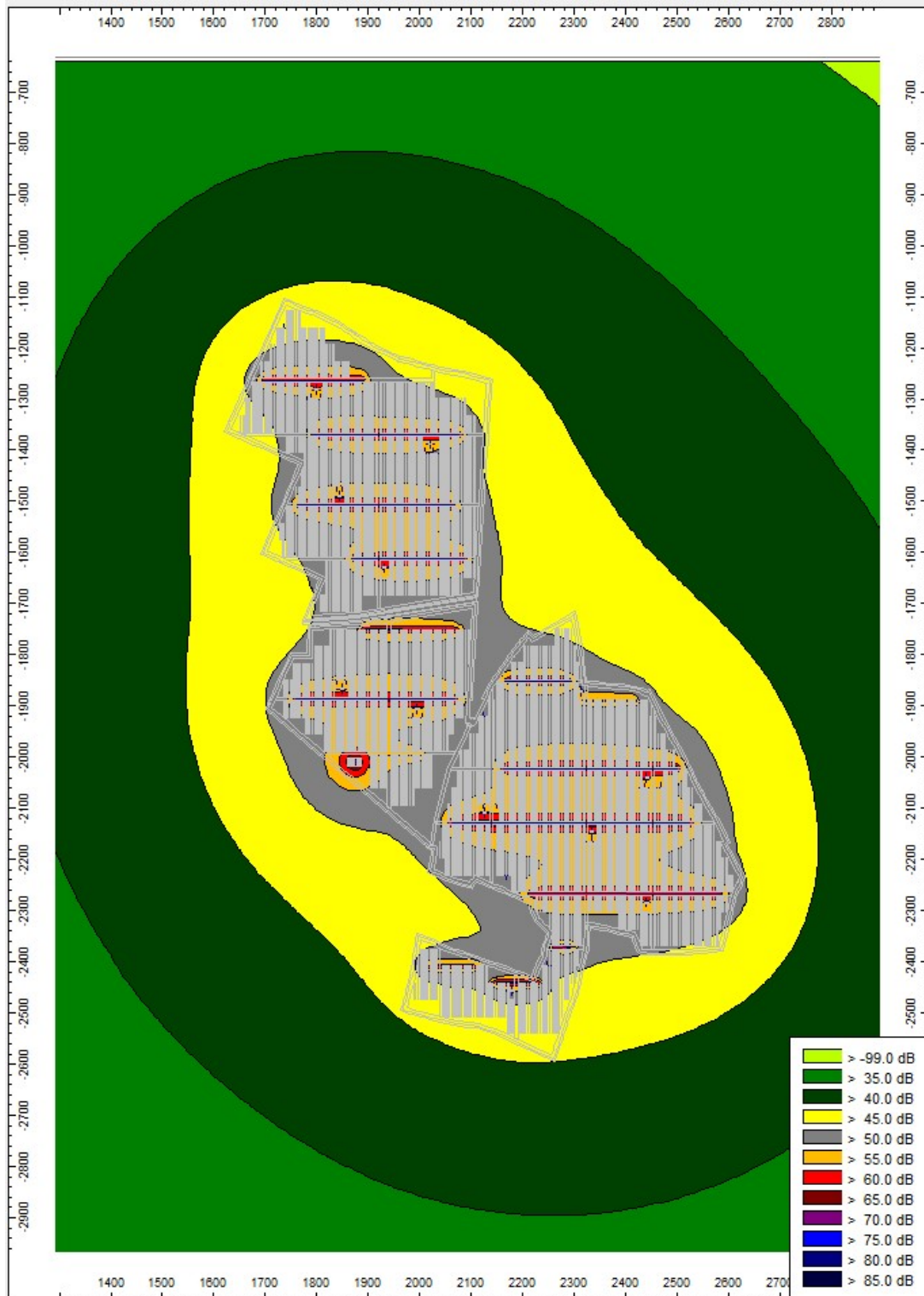
Figura III - Isoniche elaborate dal software previsionale CadnaA DataKustik FATTORIA SOLARE SIAMAGGIORE 1 - Livelli di pressione sonora previsti
