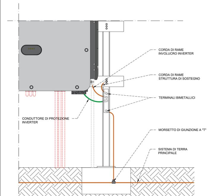
DETTAGLIO A - POZZETTO DI TERRA CON DISPERSIONE A CROCE
