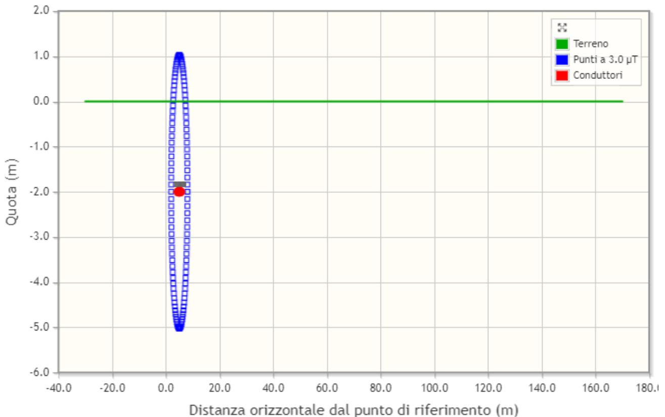
Si può quindi considerare che l'ampiezza della fascia di rispetto con valore del campo magnetico indotto inferiore a  $3\mu\text{T}$  sia pari a 3,2m, a cavallo dell'asse del cavidotto. Infine, poiché in un cavo schermato il campo elettrico esterno allo schermo è nullo, non è rappresentato il calcolo del campo elettrico prodotto dalla linea in oggetto.
