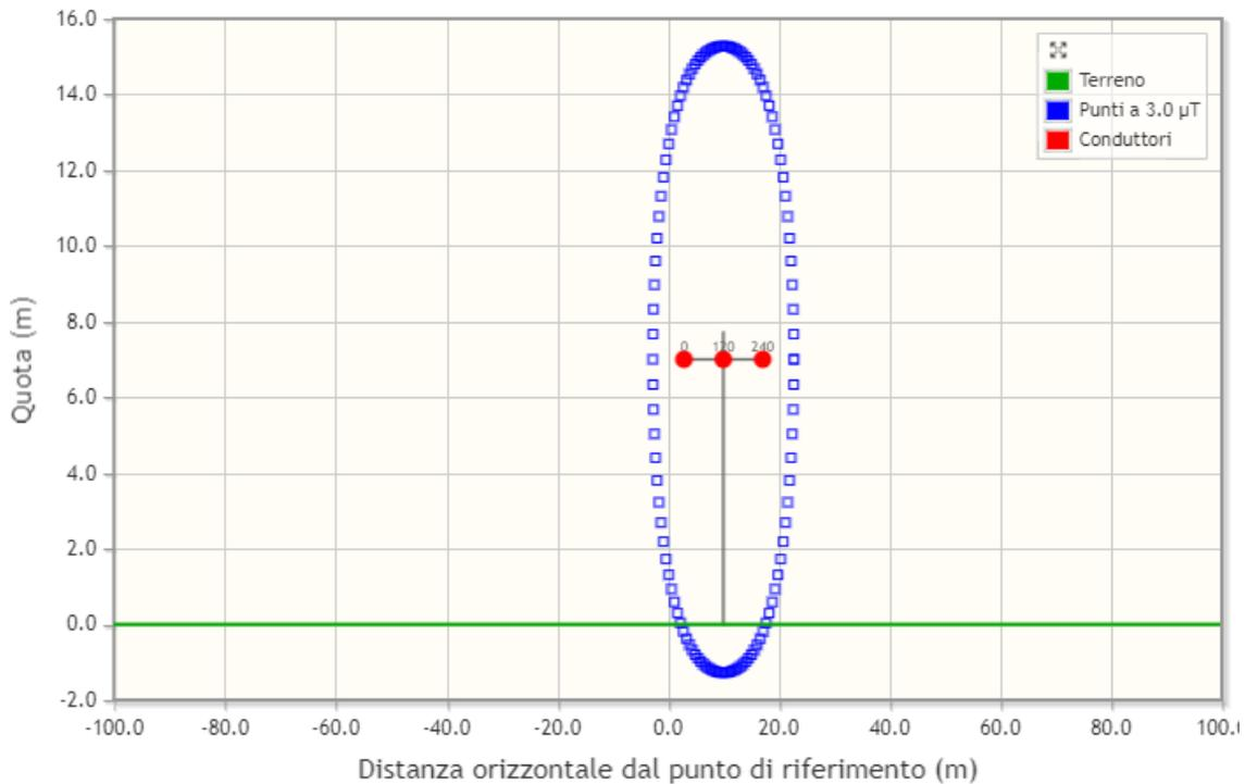
Come si può notare, ad una distanza di 10m dall'asse del sistema di sbarre l'induzione magnetica è inferiore a  $3\mu\text{T}$ .
