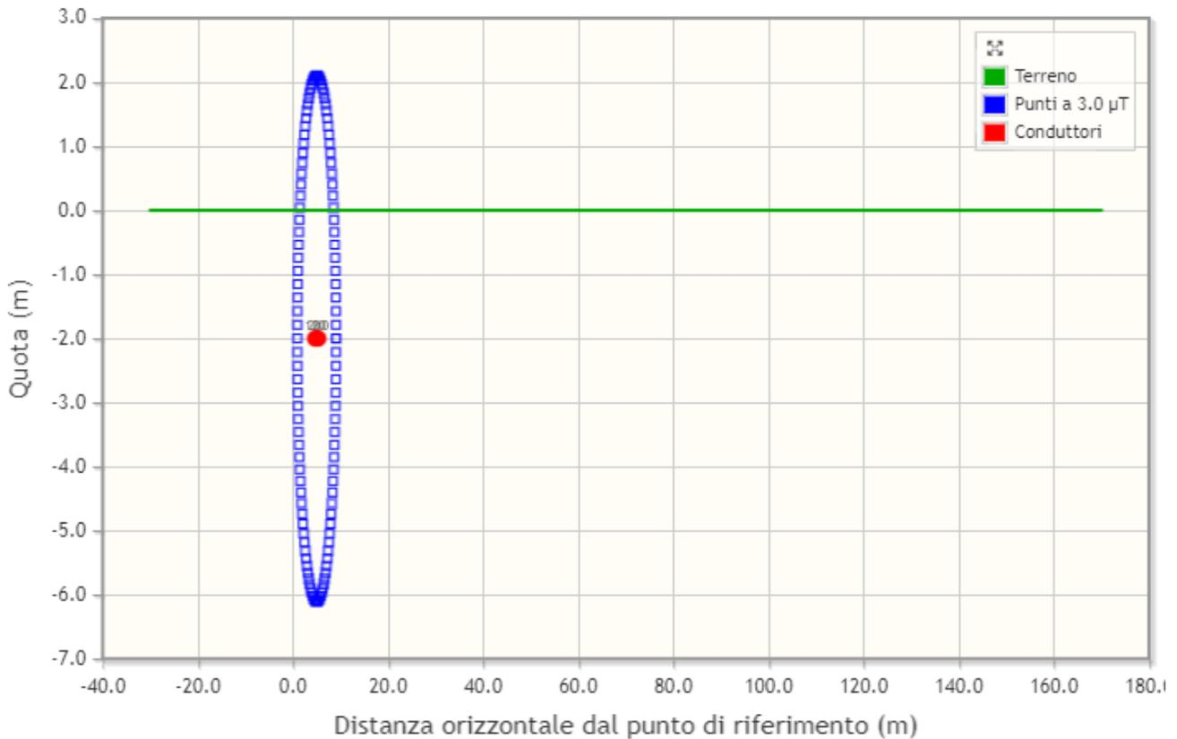
Si può quindi considerare che l'ampiezza della fascia di rispetto con valore del campo magnetico indotto inferiore a  $3\mu\text{T}$  sia pari a 4m, a cavallo dell'asse del cavidotto. Infine, poiché in un cavo schermato il campo elettrico esterno allo schermo è nullo, non è rappresentato il calcolo del campo elettrico prodotto dalla linea in oggetto.
