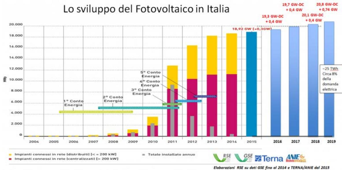
**Figura 1 – Lo sviluppo del fotovoltaico in Italia**
