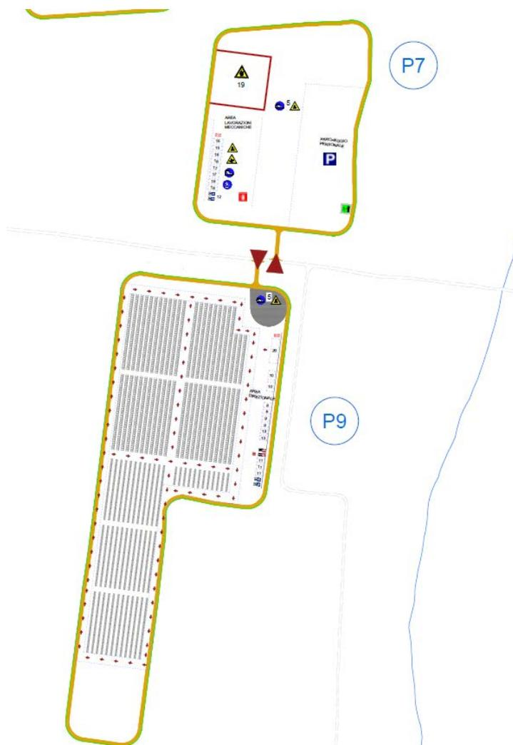
Fig.3 – Ricezione, stoccaggio e movimentazione materiali, dettaglio apprestamenti piastra 7 e 9 (cantiere 1)
