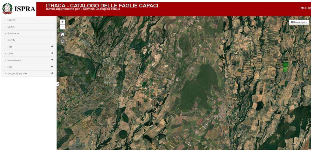
Nella figura si nota come Arlena di Castro non sia interessata da faglie capaci (*una faglia è definita capace quando ritenuta in grado di produrre, entro un intervallo di tempo di interesse per la società, una deformazione/dislocazione della superficie del terreno, e/o in prossimità di essa*).
