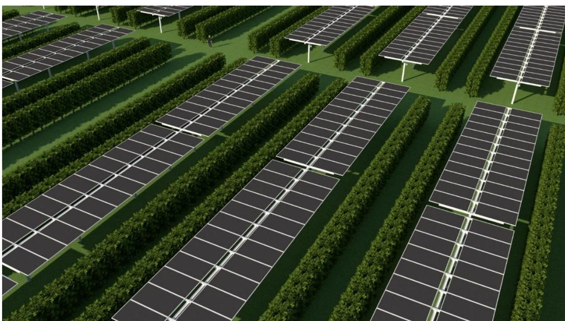
*Figura 19- Schizzo dell'assetto impiantistico: un filare FV e due siepi ulivicole alternate*
