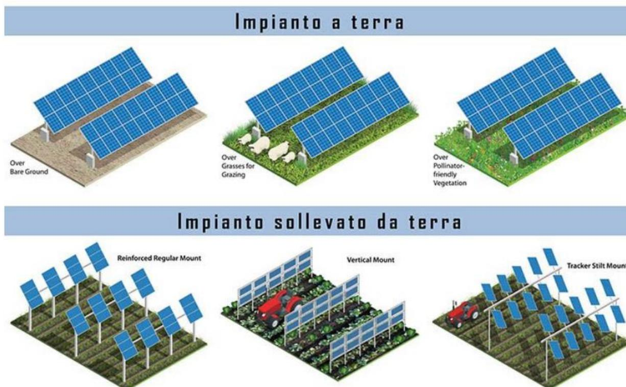
Figura 21 - Tipologie di impianti agrivoltaici, fonte NREL
