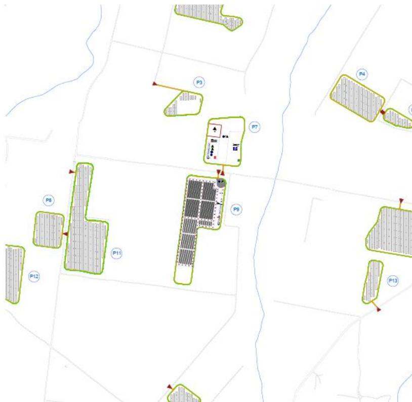
*Figura 130 - Area di cantiere 1 - fase installazione strutture e moduli*
