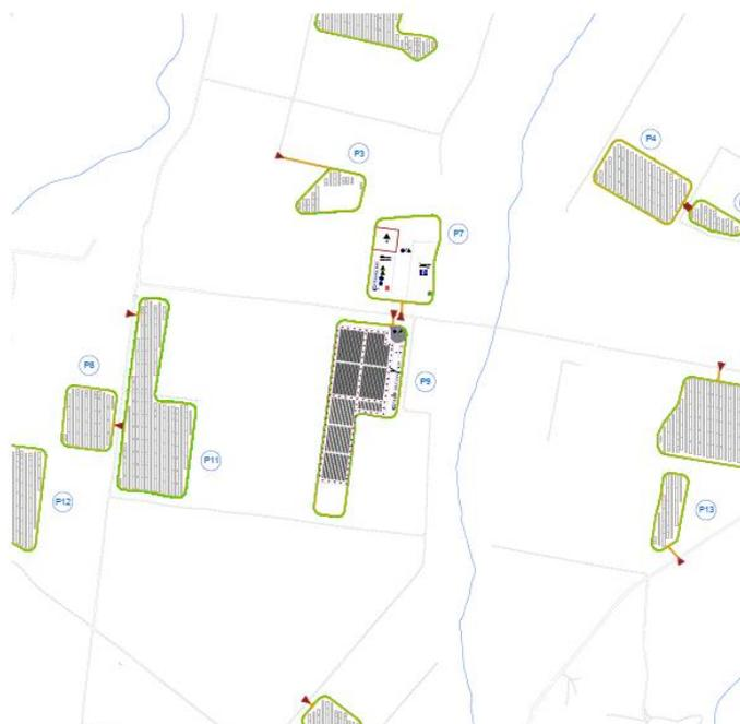
*Figura 90 - Area di cantiere 1 - fase installazione strutture e moduli*
