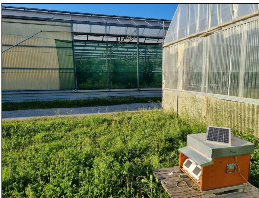
Figura 42: Arnia posizionata nell’impianto calabrese di Scalea. Si nota un piccolo pannello solare posto sull’arnia, che mantiene attivi i sensori per misurare i parametri di seguito descritti ed il sistema di monitoraggio dei voli all’ingresso dell’arnia.
