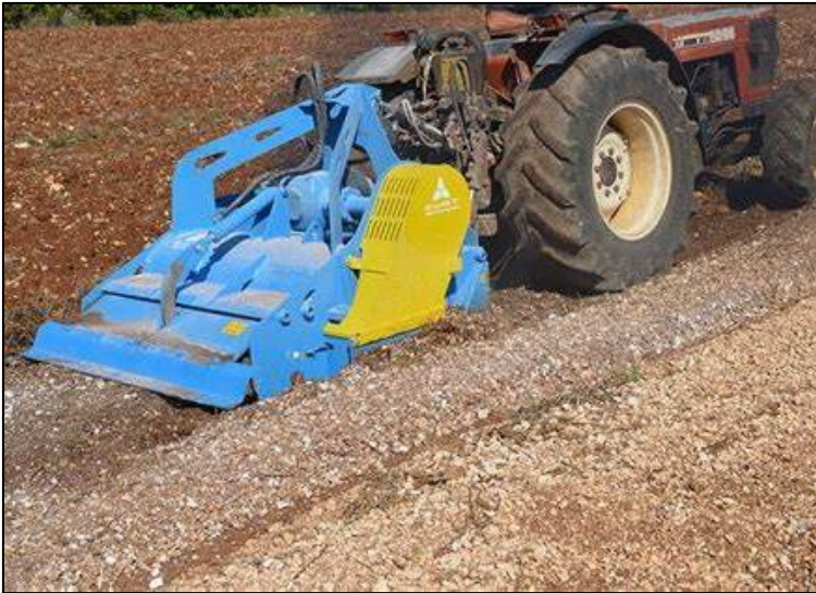
Figura 24: Il macchinario illustrato è una fresa a picchi e l'immagine è esplicativa dell'azione di frantumazione dello strato superficiale.
