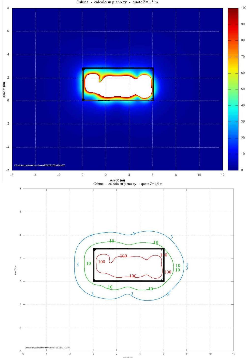
Figura 31: PS (1° e 3° anello), h = 1,5 m, mappa 2D e curve isolivello
