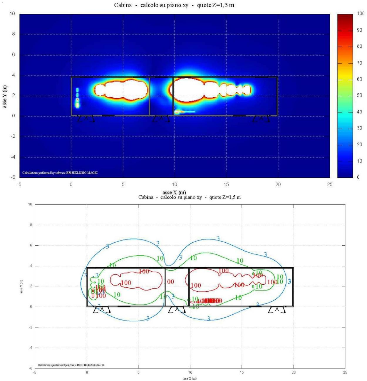
Figura 28: Cabina di Raccolta,  $h = 1,5$  m, mappa 2D e curve isolivello
