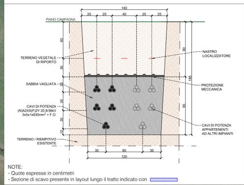
**SEZIONE DI SCAVO - TIPO 3 (SCALA 1:20)**
