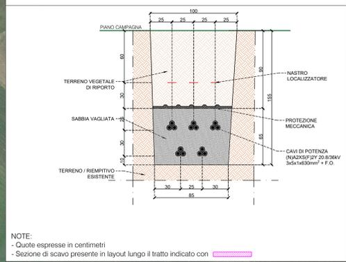
**SEZIONE DI SCAVO - TIPO 2 (SCALA 1:20)**
