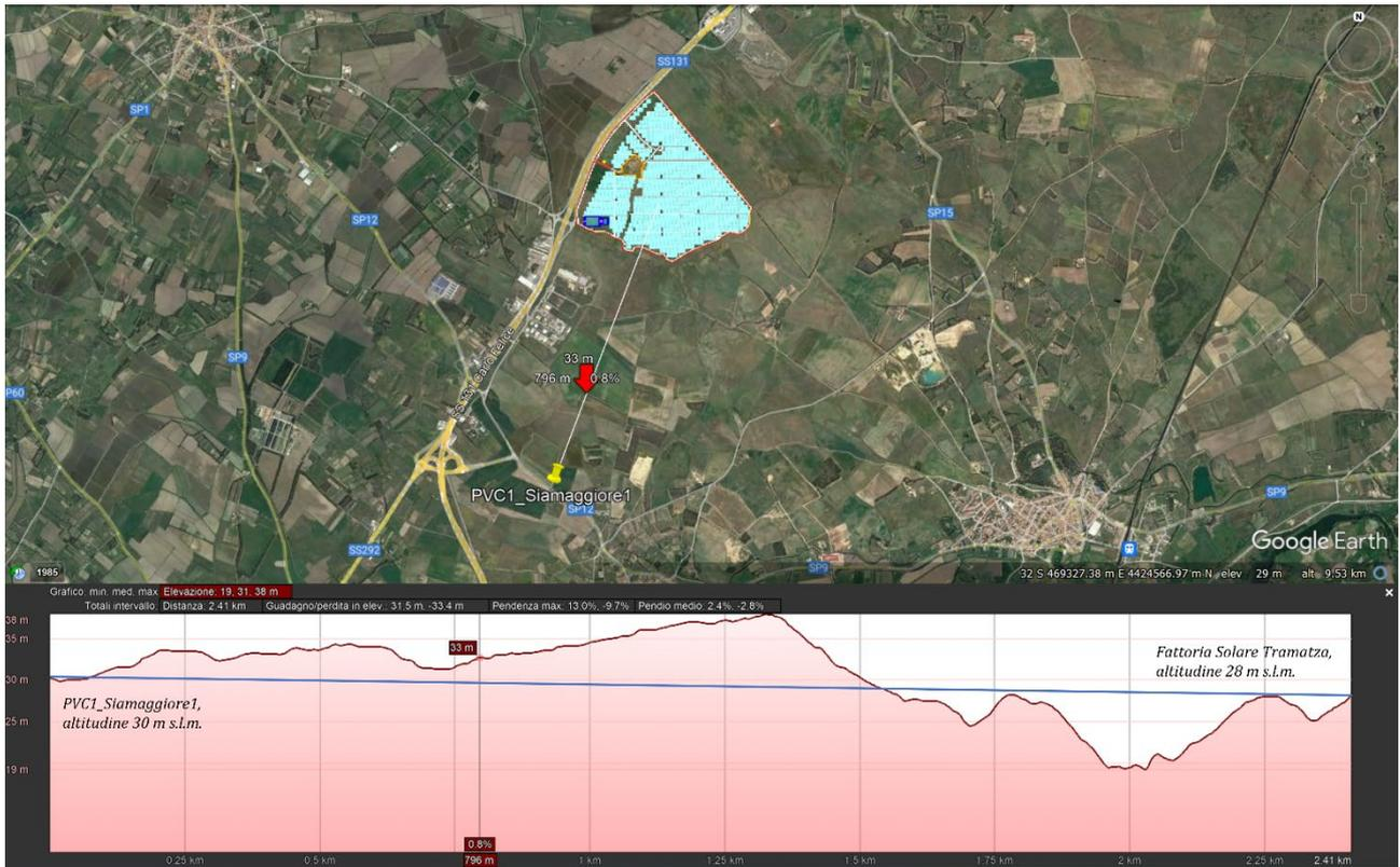
*Figura 40: Profilo altimetrico della direttrice di collegamento tra il PVC1 e l'area d'impianto*
