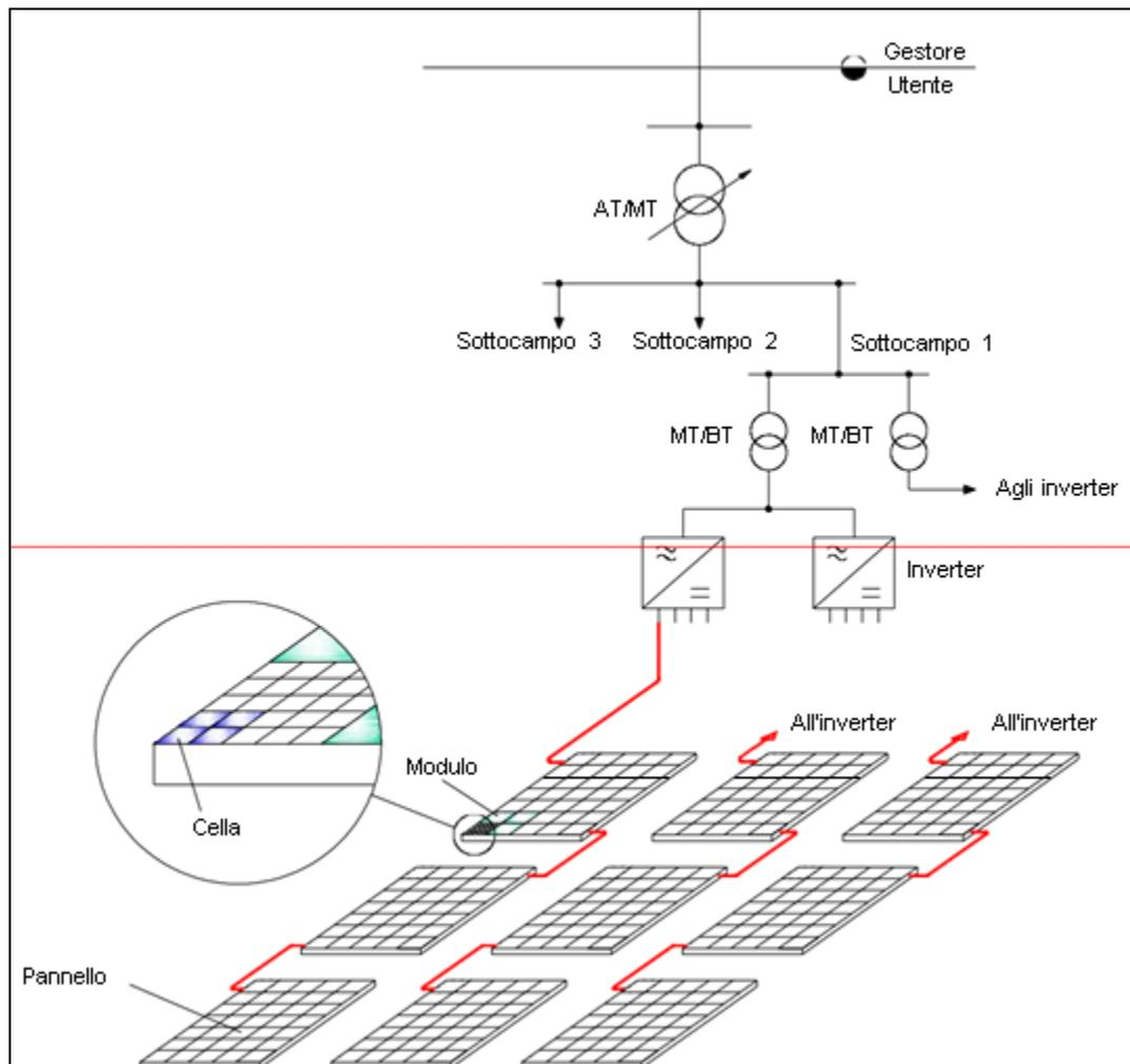
**Figura 1: Schema collegamento centrale fotovoltaica**
