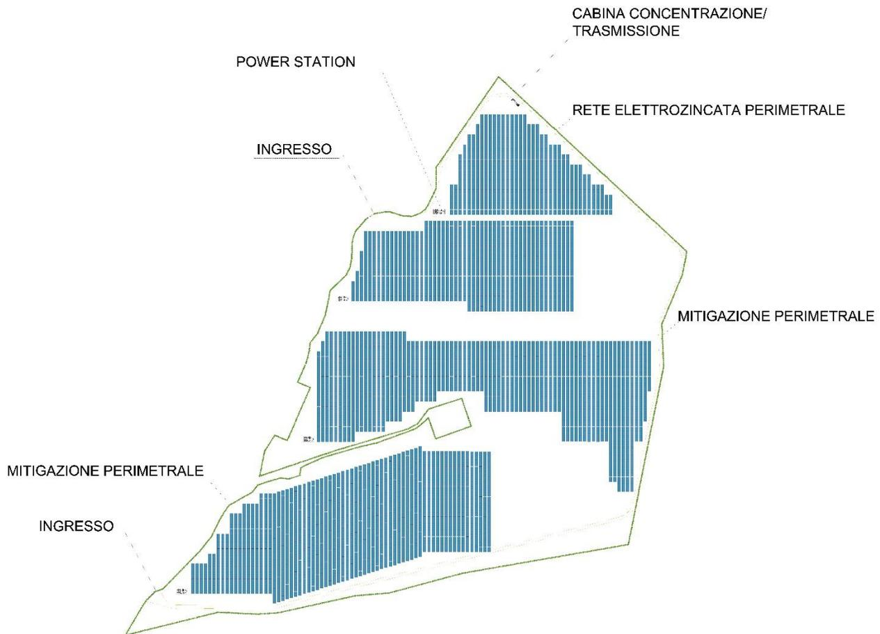
L'impianto in progetto, del tipo ad inseguimento monoassiale (inseguitori di rotolo), prevede l'installazione di strutture di supporto dei moduli fotovoltaici (realizzate in materiale metallico), disposte in direzione Nord-Sud su file parallele ed opportunamente spaziate tra loro (interasse di 7,50 m), per ridurre gli effetti degli ombreggiamenti.
