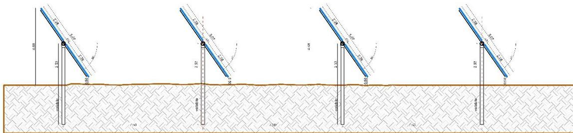
L'inseguitore solare serve ad ottimizzare la produzione elettrica dell'effetto fotovoltaico (il silicio cristallino risulta molto sensibile al grado di incidenza della luce che ne colpisce la superficie) ed utilizza la tecnica del backtracking, per evitare fenomeni di ombreggiamento a ridosso dell'alba e del tramonto.
