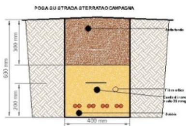
Figura 30 - Particolare sezione tipo cavo interrato BT
