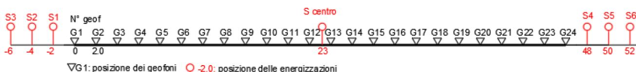
Figura 44 Schema geometrico di acquisizione dei dati per gli stendimenti di lunghezza L = 46,0 m
