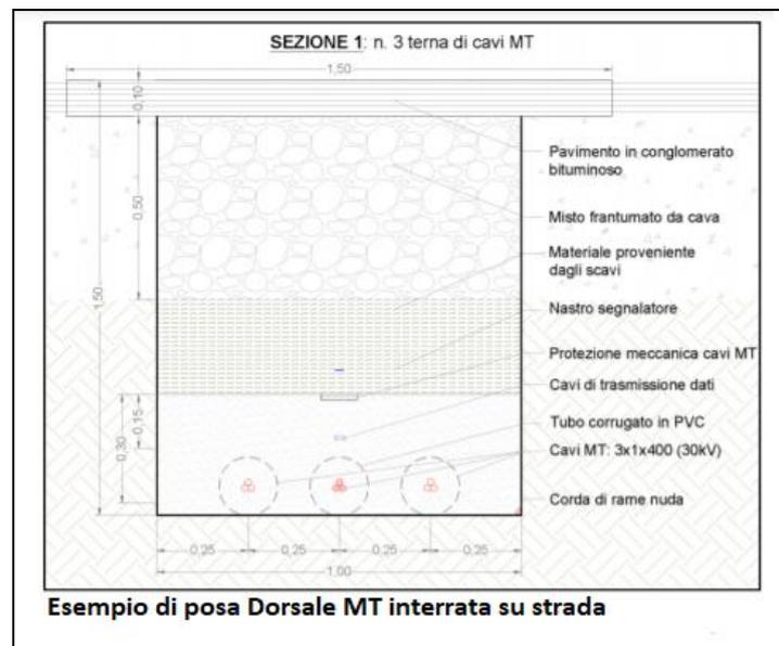
Figura 8 Sezioni tipo della trincea per la posa dei cavidotti
