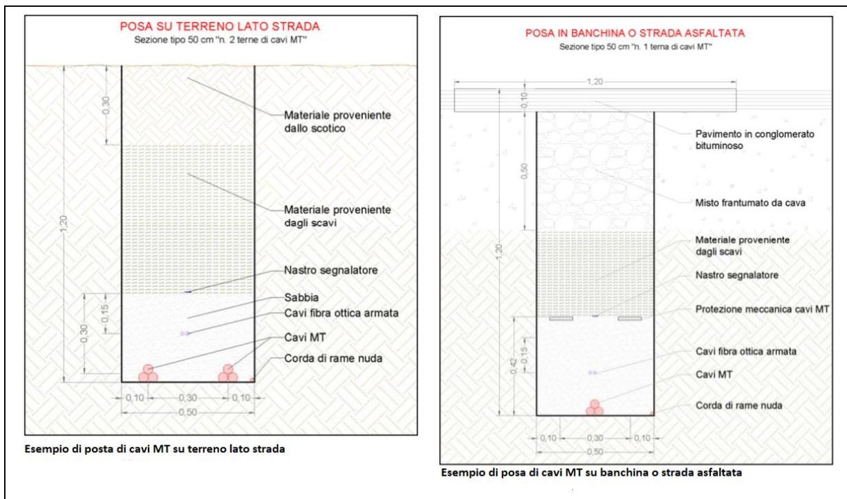
Figura 7 Sezioni tipo della trincea per la posa dei cavidotti
