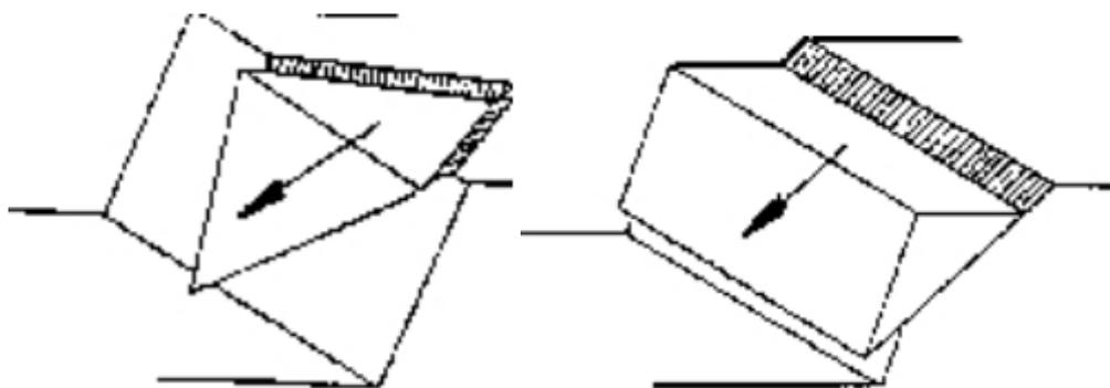
Figura 12 Tipologie di scivolamento di blocchi rocciosi lungo piani di fratturazione
