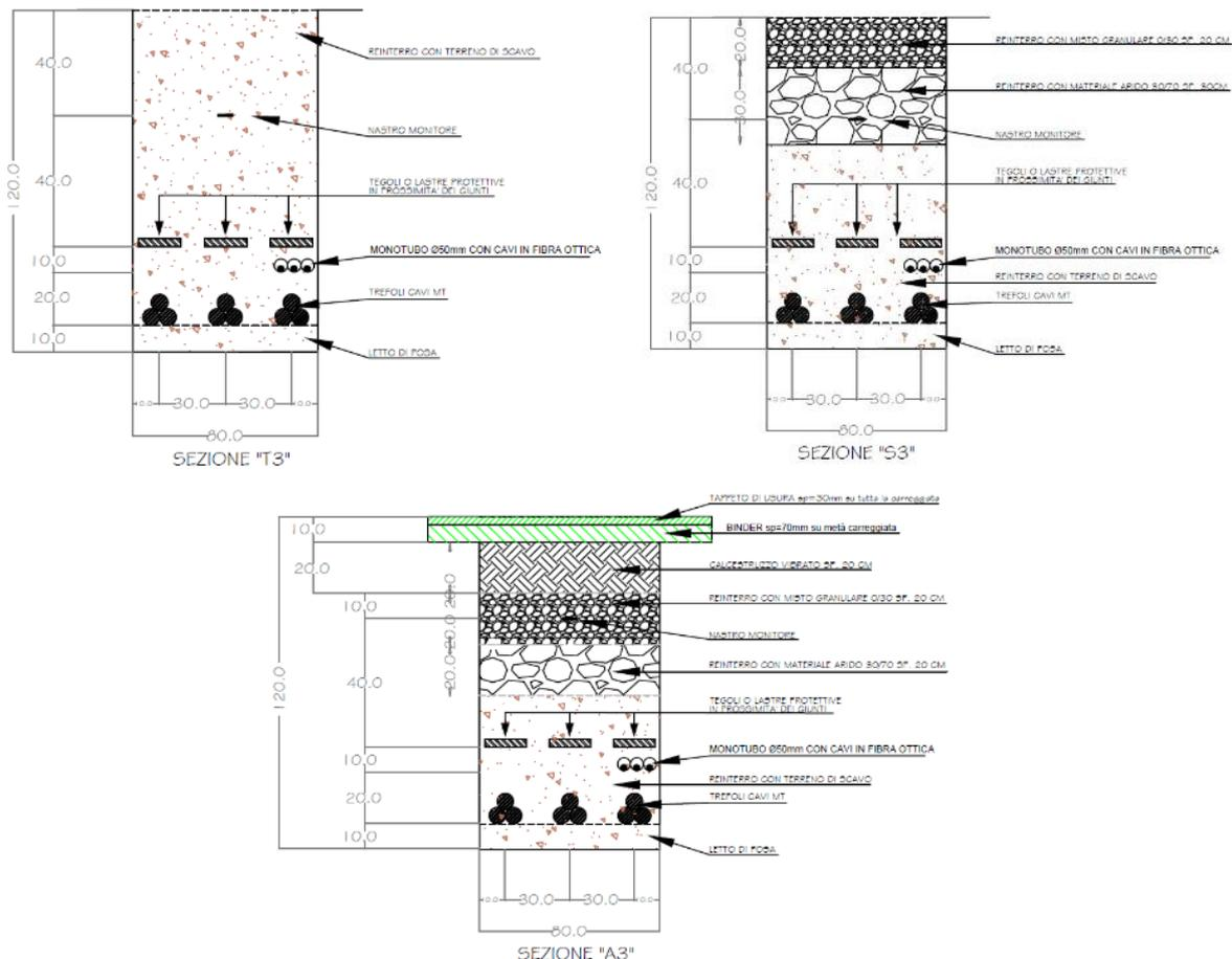
Figura 44 - Tipici posa cavidotto
