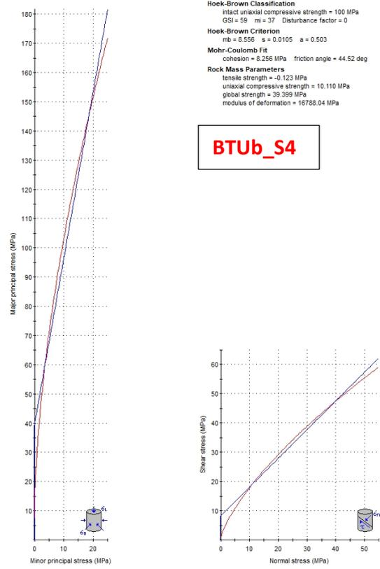
Figura 42 Valori di Coesione e angolo di attrito interno ottenuti utilizzando il software RocData nella Facies di Orune
