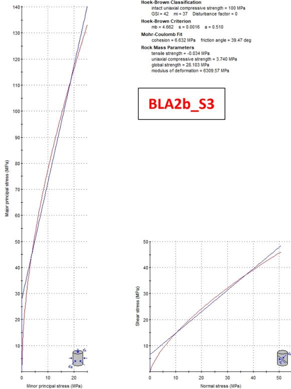
Figura 43 Valori di Coesione e angolo di attrito interno ottenuti utilizzando il software RocData nella Facies di Orune
