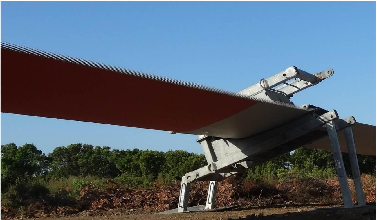
**Figura 35: pala di aerogeneratore con bande dentellate.**
