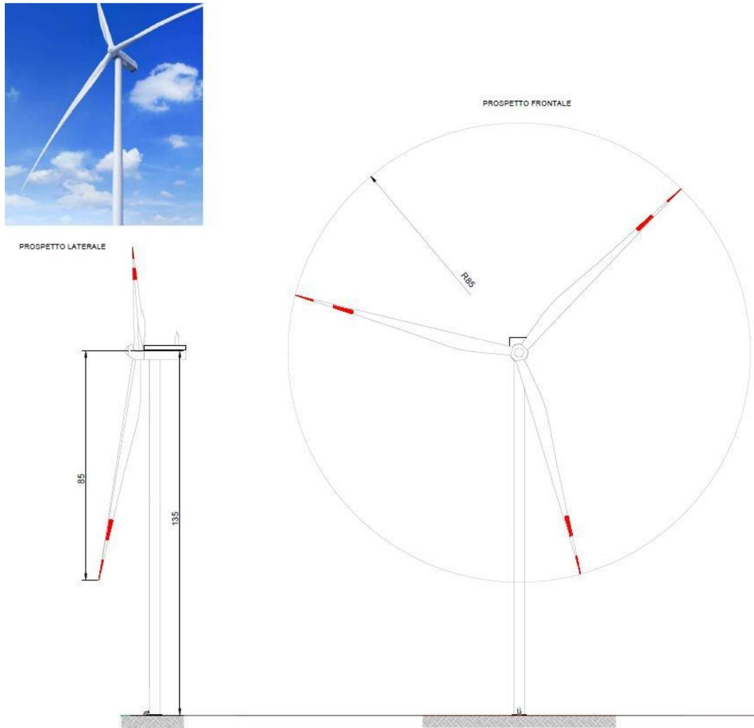
Figura 6 - Struttura aerogeneratore.
