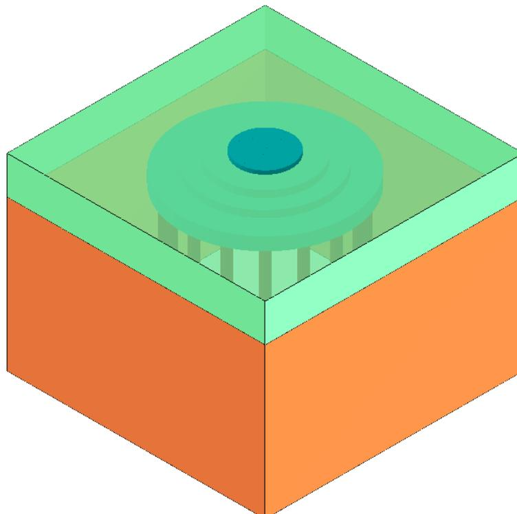
Figura 4 - Modellazione fondazione e stratigrafia
