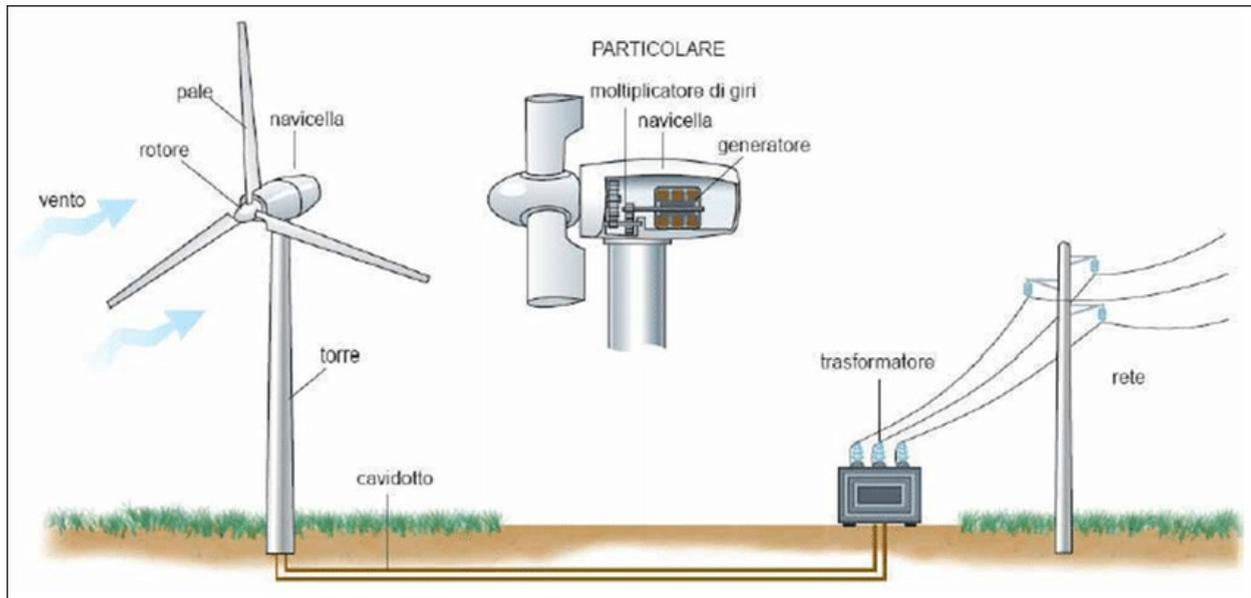
Figura 17 - Schematizzazione impianto eolico
