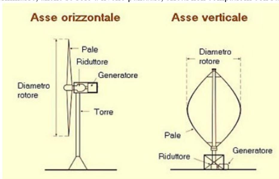
Figura 20 - Schemi di funzionamento degli aerogeneratori ad asse orizzontale vs verticale
