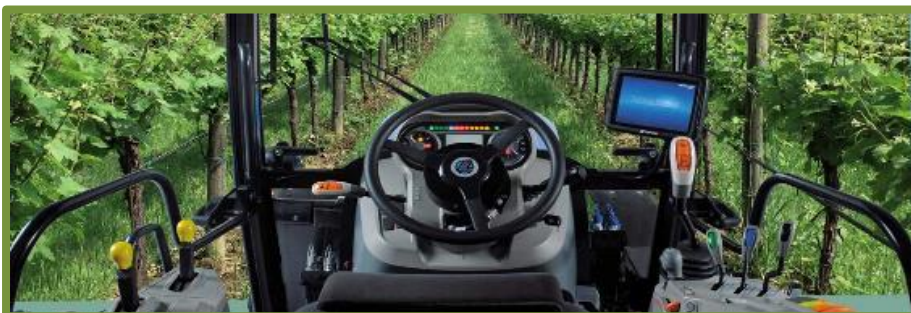
Fig. 67 interno cabina trattore con strumentazione per l'agricoltura di precisione.
