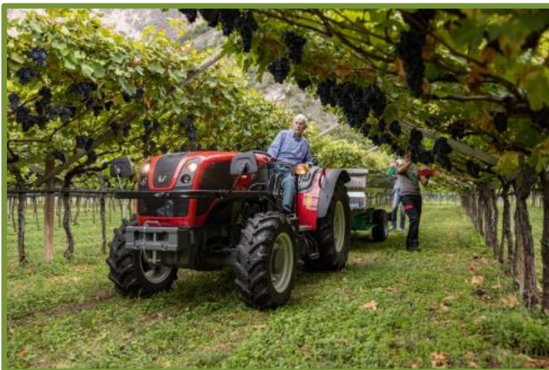
Fig. 92 Esempio di trattore da frutteto adatto per lavorare con uno spazio in altezza limitato.
