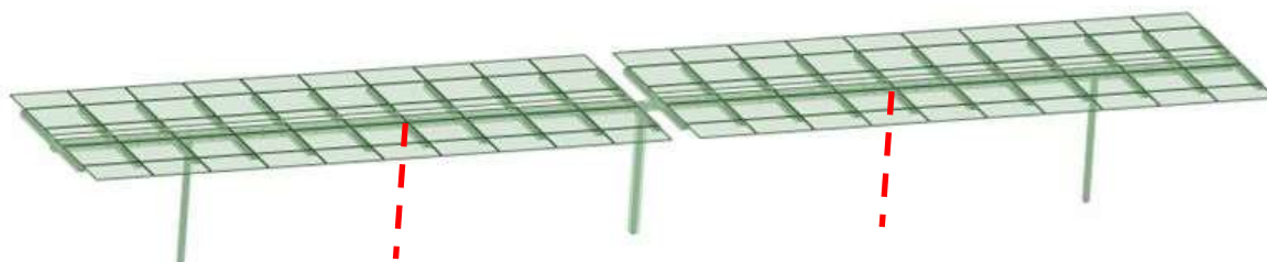
Figura 5-3: Schema indicativo di un tracker (3 o 5 supporti)
