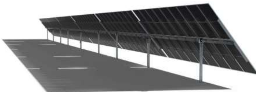
Figura 5-7 - Render della struttura di un tracker a 3 montanti
