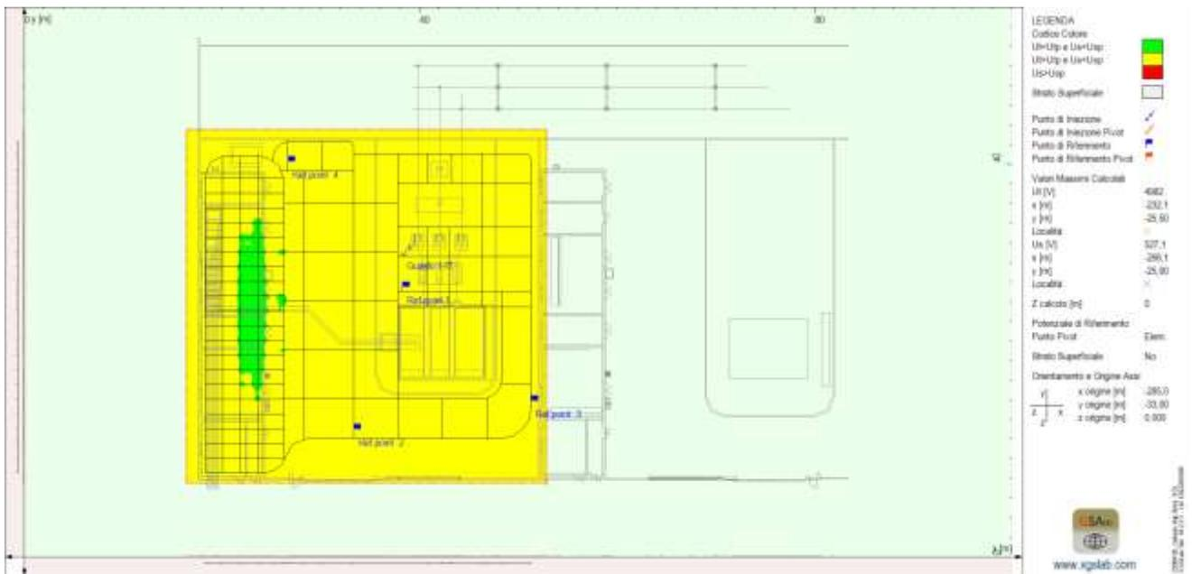
Fig. 13 rappresenta un confronto tra le tensioni di contatto  $U_t$  e di passo  $U_s$ , calcolate a partire dalla distribuzione di  $\phi$  (
