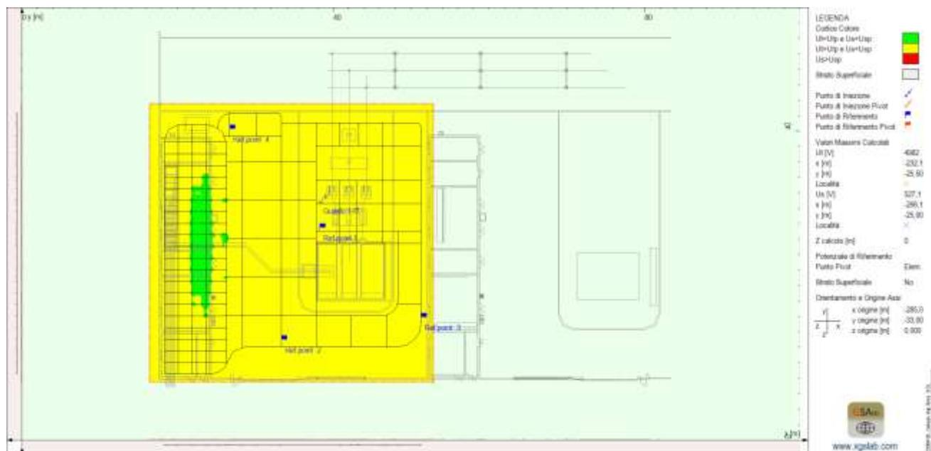
Fig. 13 - Confronto tra tensioni di contatto e di passo ed i relativi limiti ammessi
